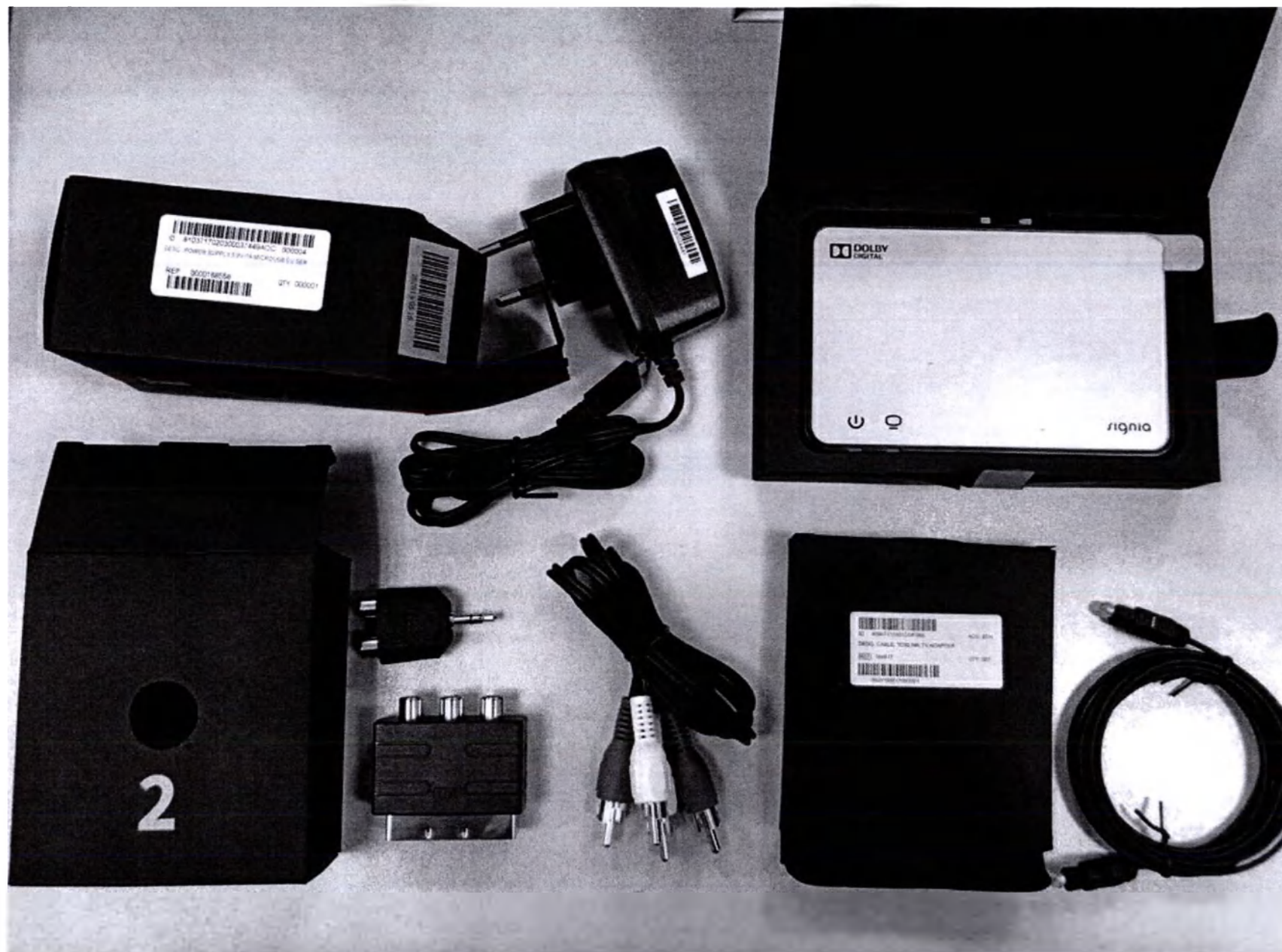
Беспроводной передатчик StreamLine TV в комплекте: основной блок StreamLine TV, блок питания с кабелем, кабель TOSLINK, переходник RCA, переходник SCART, переходник мини-джек.
