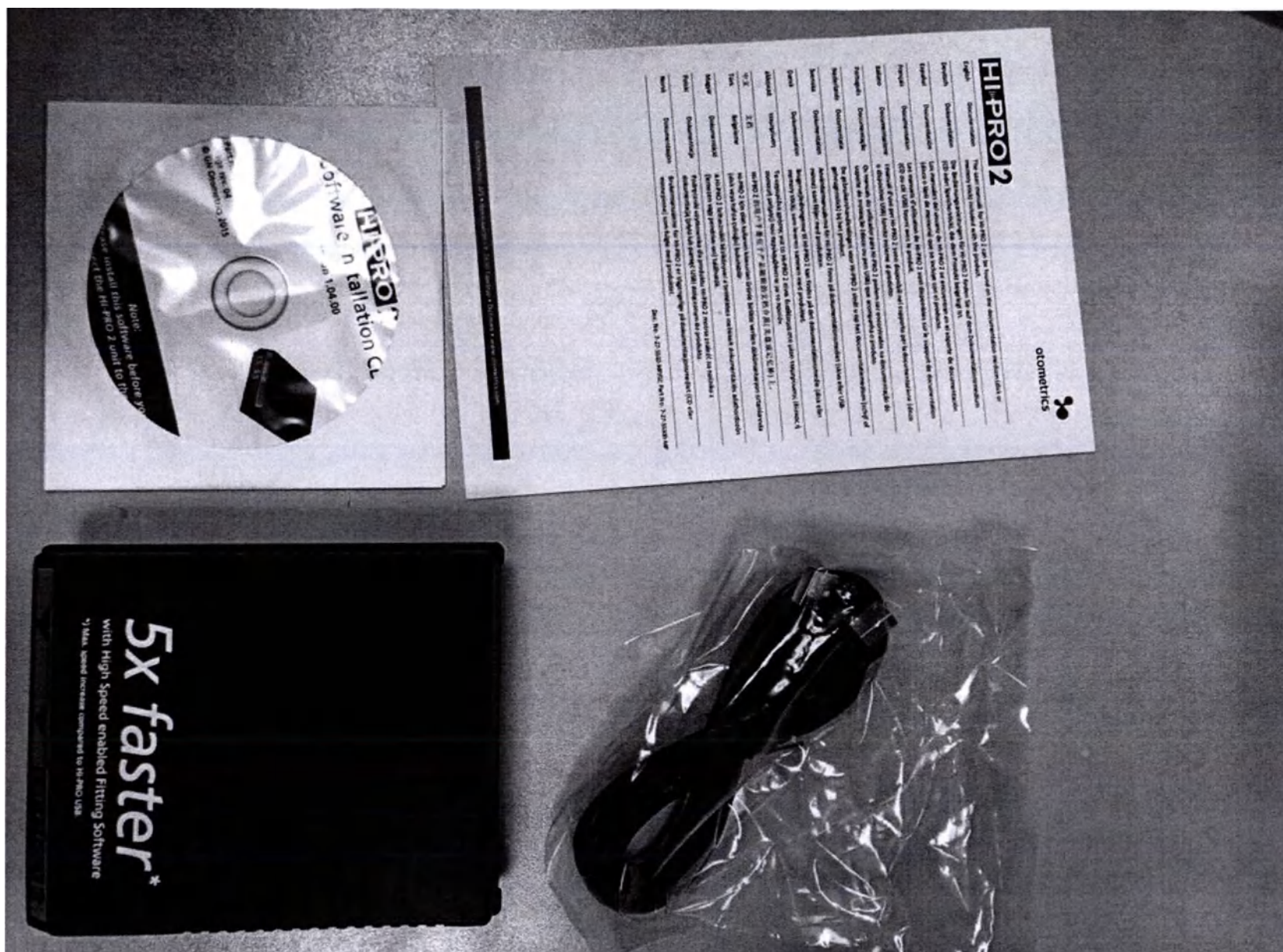
Программатор Hi-PRO 2 USB в комплекте: основное устройство Hi-PRO 2, USB-кабель, установочный компакт диск, руководство по установке.
