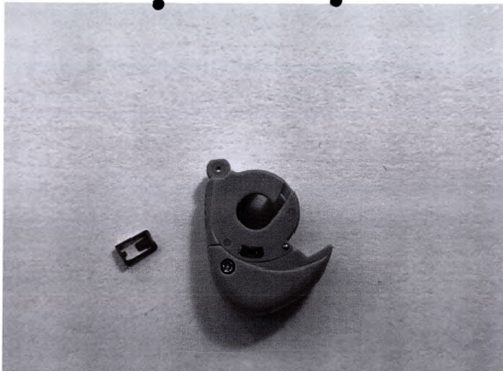
Отсек батарейный сменный с индукционной катушкой TELECOIL SHOE SET H2940 в комплекте: отсек батарейный сменный с индукционной катушкой, индикатор красный INDICATOR CLIP RED.
