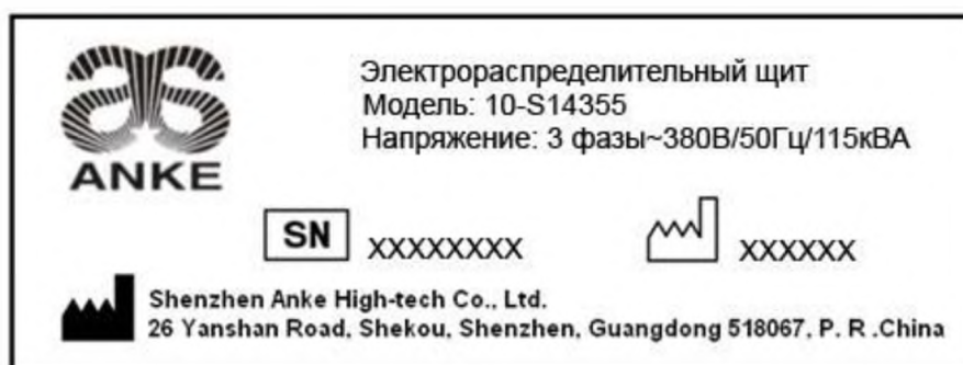
Рисунок 2-19 Маркировка электрораспределительного щита
