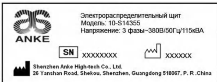
Рисунок А-38 Маркировка электрораспределительного щита
