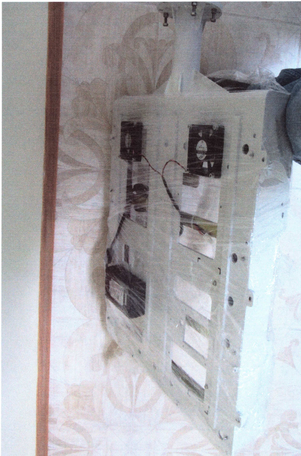
Защитный кожух детектора с креплением детектора и камеры экспонометра
