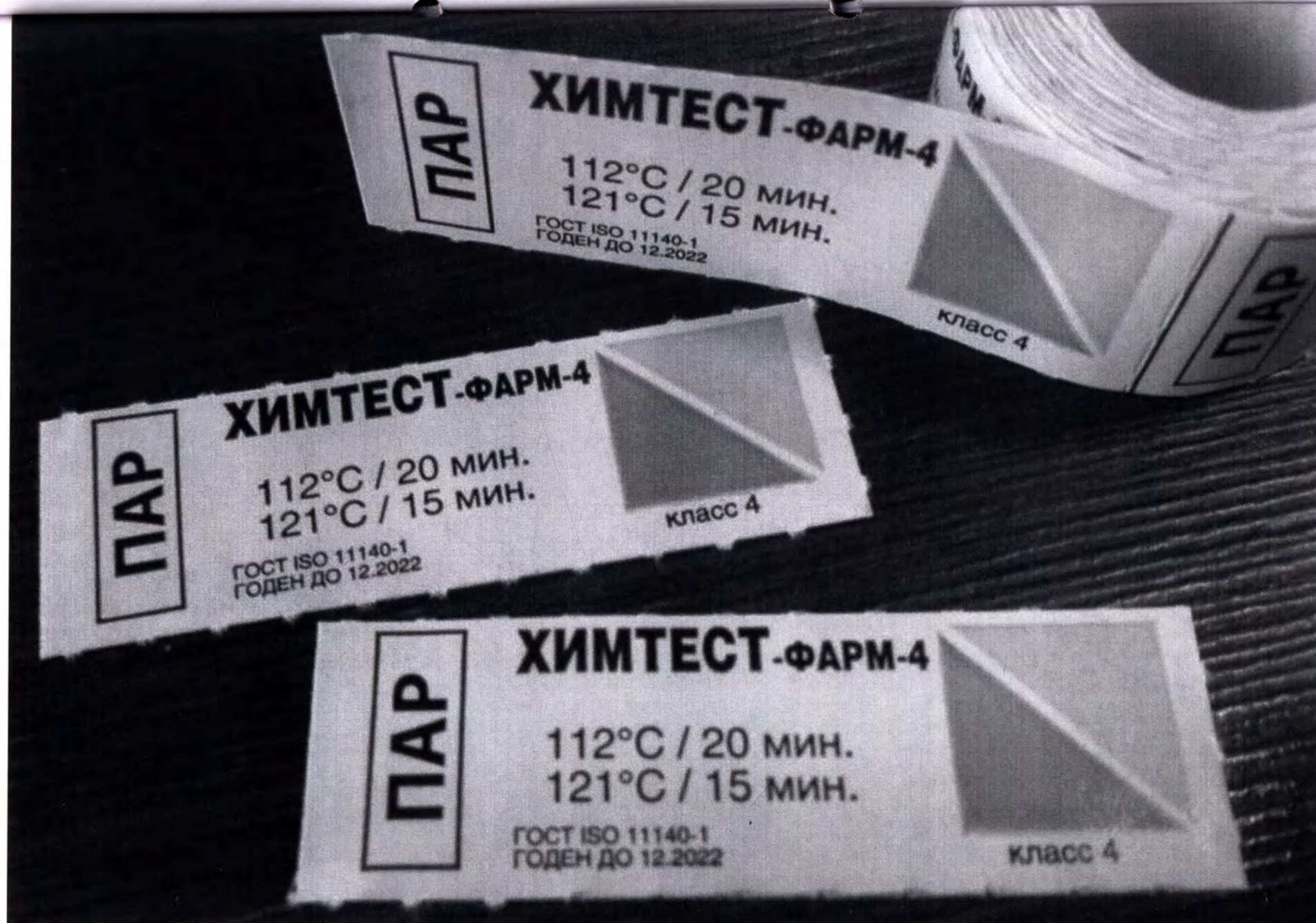
Многoperеменный индикатор «ХимТест-Фарм-4», 4 класс для контроля параметров паровой стерилизации для режимов: 112 °С /20 мин, 121 °С /15 мин (отдельные индикаторы в рулоне)
