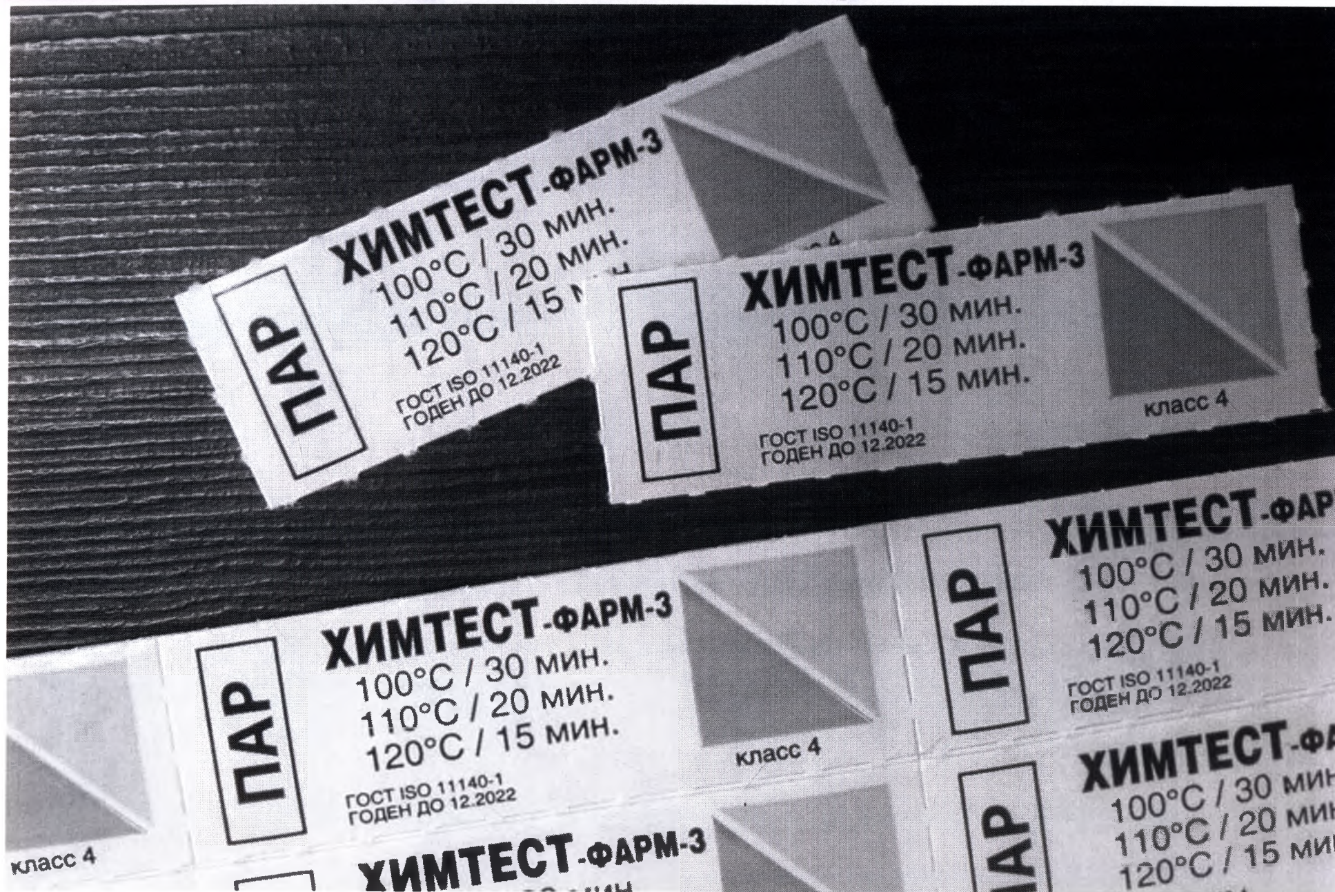
Многопеременный индикатор «ХимТест-Фарм-3», 4 класс для контроля параметров паровой стерилизации для режимов: 100 °C / 30 мин, 110 °C / 20 мин, 120 °C / 15 мин (отдельные индикаторы в листе)
