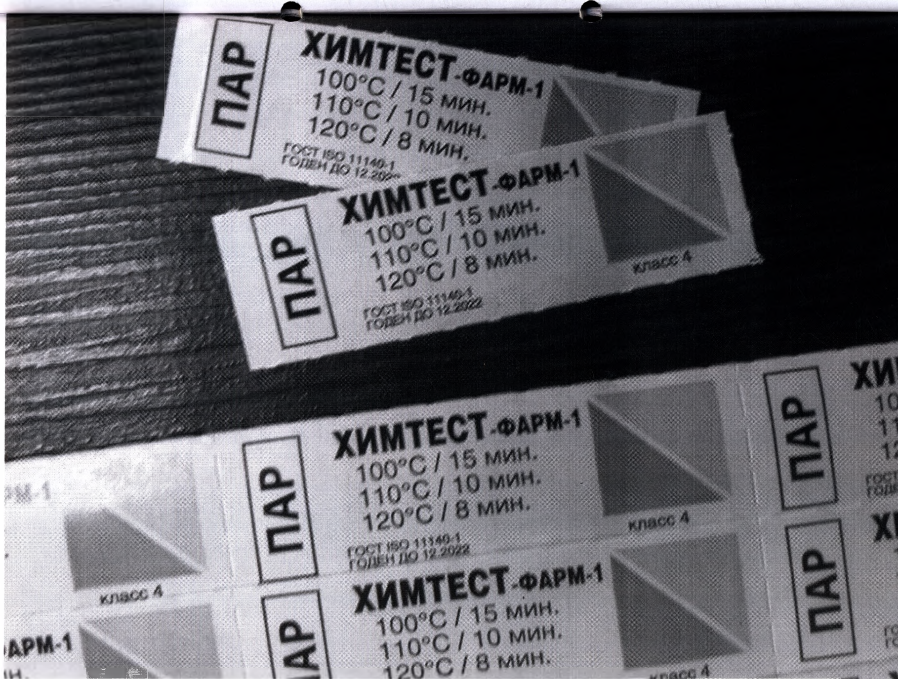
Многoperеменный индикатор «ХимТест-Фарм-1», 4 класс для контроля параметров паровой стерилизации для режимов: 100 °C / 15 мин, 110 °C / 10 мин, 120 °C / 8 мин (отдельные индикаторы в листе)
