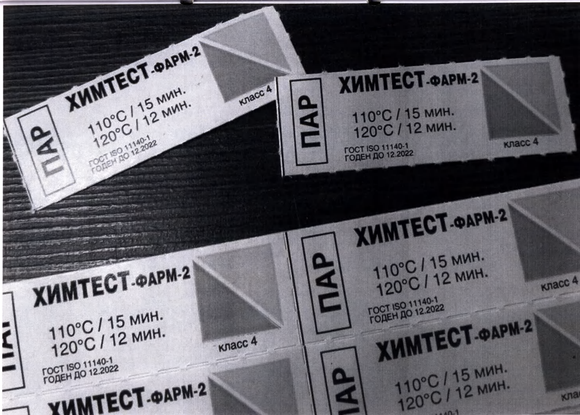
Многoperеменный индикатор «ХимТест-Фарм-2», 4 класс для контроля параметров паровой стерилизации для режимов: 110°C /15 мин, 120°C /12 мин (отдельные индикаторы в листе)
