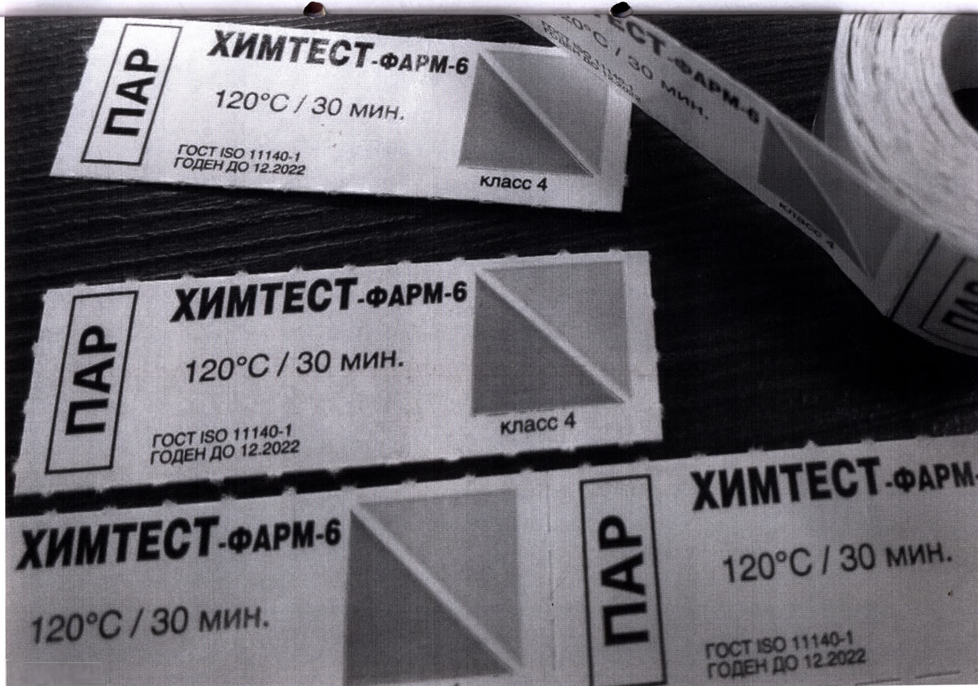
Многопеременный индикатор «ХимТест-Фарм-6», 4 класс для контроля параметров паровой стерилизации для режима: 120°C / 30 мин (отдельные индикаторы в рулоне)
