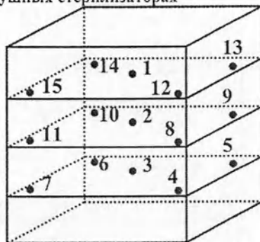
Расположение контрольных точек в воздушных стерилизаторах
