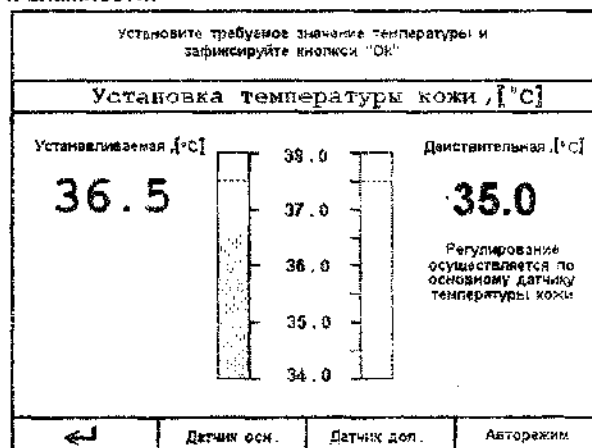
Рисунок 2.4.6 – Изображение экрана при включении режима регулирования по коже
