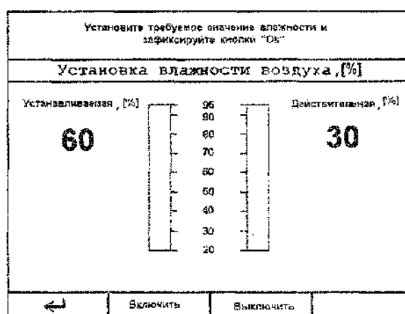
Рисунок 2.4.11 – Изображение экрана при включении режима установки влажности
