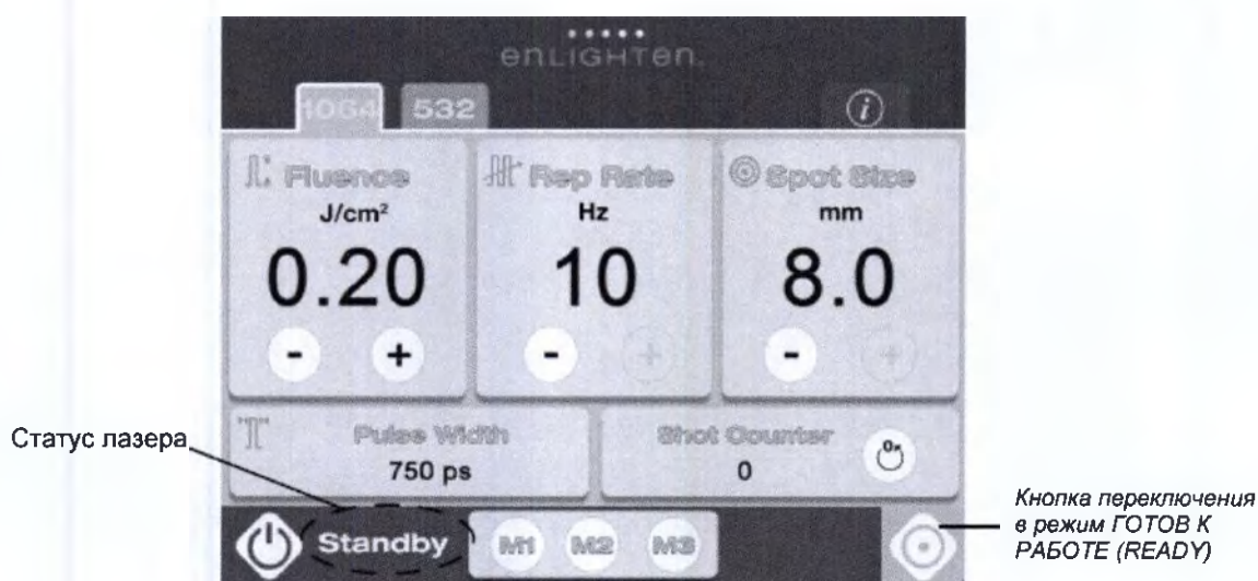
Экран «Обработка» в режиме ОЖИДАНИЯ (STANDBY)
