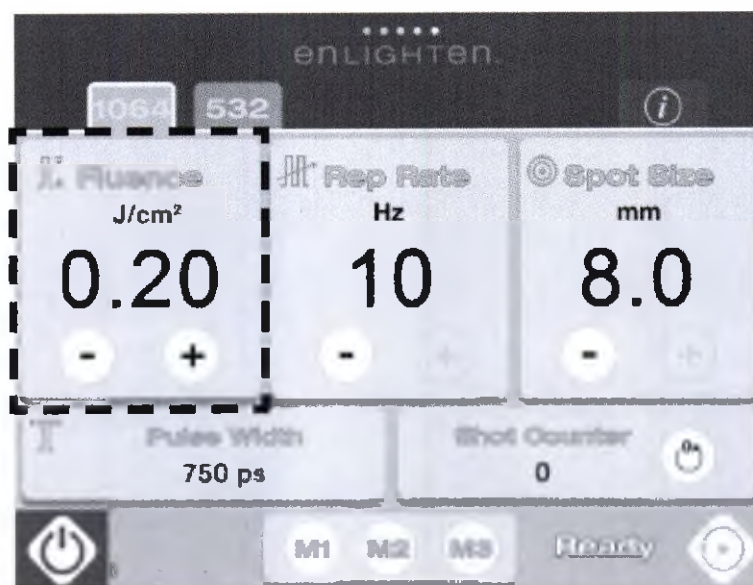
Расположение дисплея и элементов управления плотностью энергии
