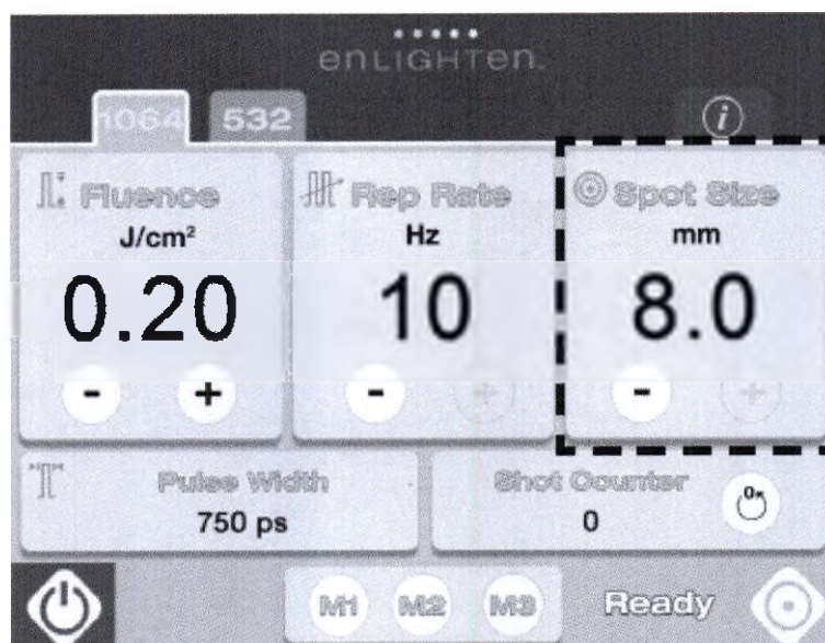
Расположение дисплея и элементов управления размером пятна
