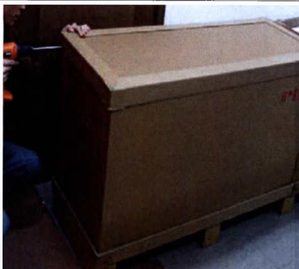
5. Фиксирование крышки шурупами
