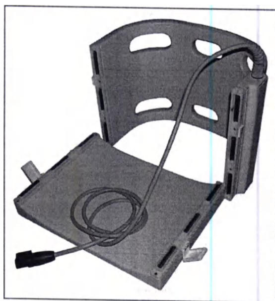
рис. 8.26 - 4-канальная поясничная катушка: фиксированная нижняя секция и съемная верхняя часть
