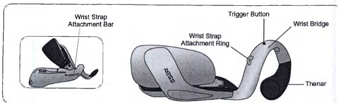
Рис. 4-4 Спиральный конец ортеза H220 Wireless. (Wrist Strap Attachment Bar- Ремешок для крепления ремешка на запястье , Wrist Strap Attachment Ring - Кольцо для крепления ремешка на запястье, Trigger Button - Кнопка триггера, Wrist Bridge- Мост запястья , Thenar- тенар)
