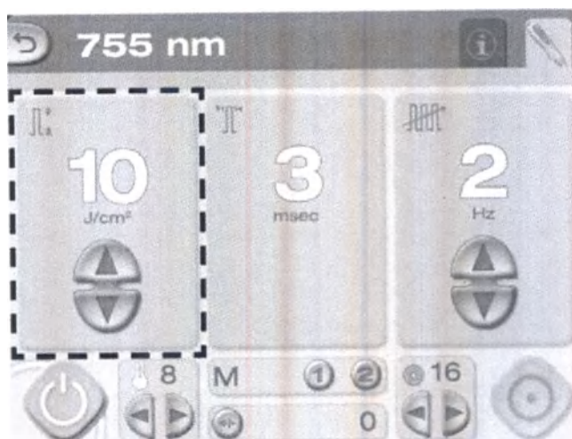
Расположение дисплея и элементов управления плотностью энергии на экране «Обработка» для лазера с длиной волны 755 нм
