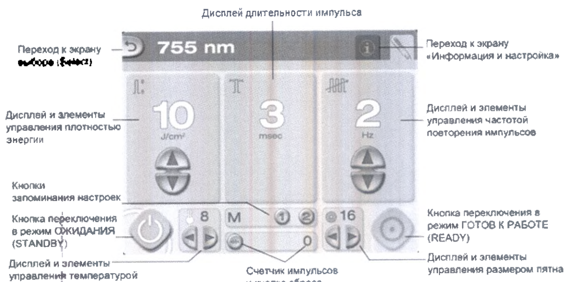
Экран «Обработка» для лазера с длиной волны 755 нм (показан режим ожидания (STANDBY))
