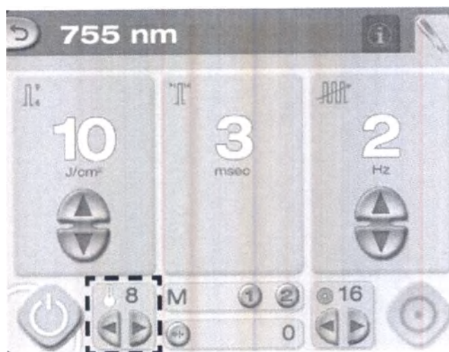
Расположение дисплея и элементов управления температурой на экране «Обработка» для лазера с длиной волны 755 нм
