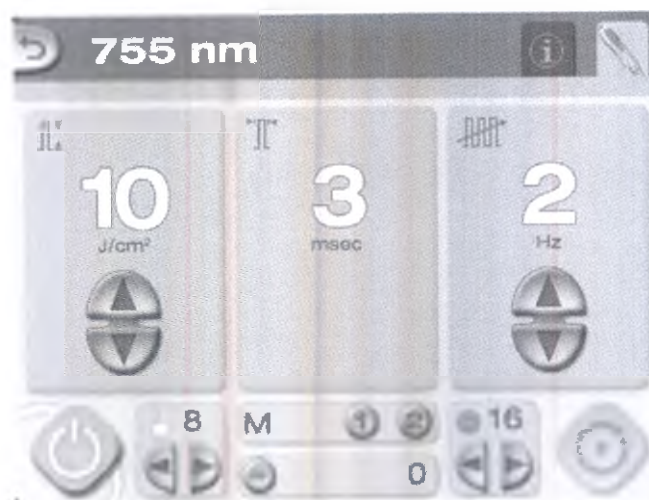
Экран «Обработка» для лазера с длиной волны 755 нм в режиме ОЖИДАНИЯ (STANDBY)
