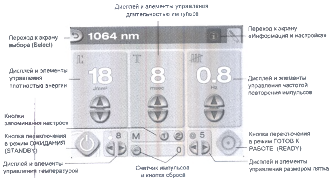
Экран «Обработка» для лазера с длиной волны 1064 нм (показан режим ожидания (STANDBY))
