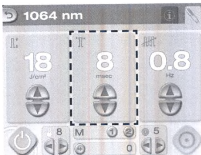
Расположение дисплея и элементов управления длительностью импульса на экране «Обработка» для лазера с длиной волны 1064 нм
