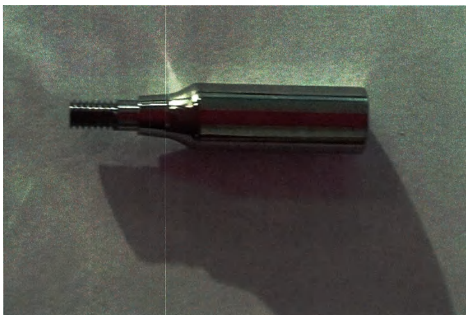
Вид Временного сварочного абатмента GH1.5 и фиксирующего винта в сборе
