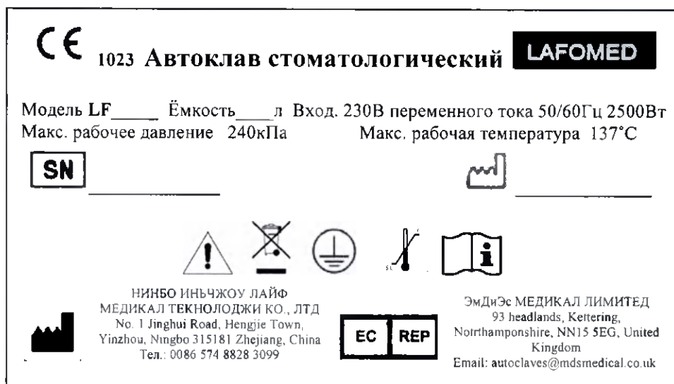
Рисунок 3 – Эскиз маркировка медицинского изделия на русском языке
