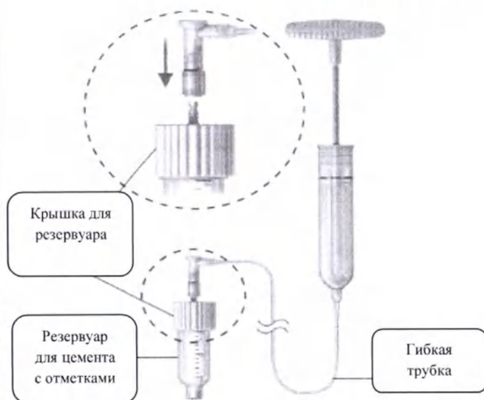
Рисунок 4: Присоединение резервуара для цемента с отметками к гидравлической помпе
