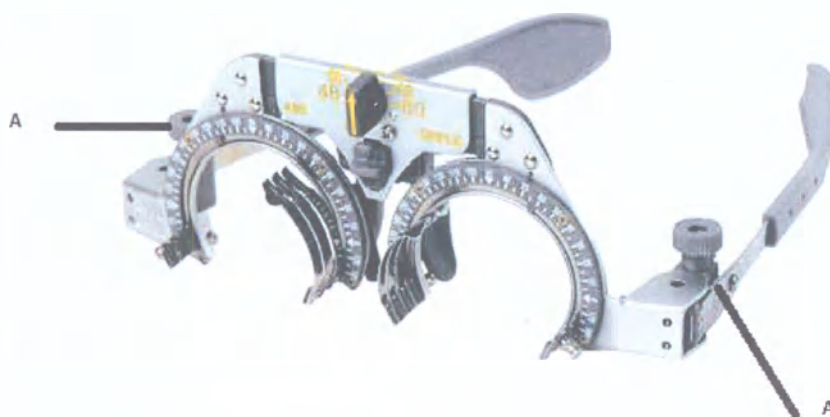
A- Винты, регулирующие угол наклона заушника (левый и правый глаз отдельно)
