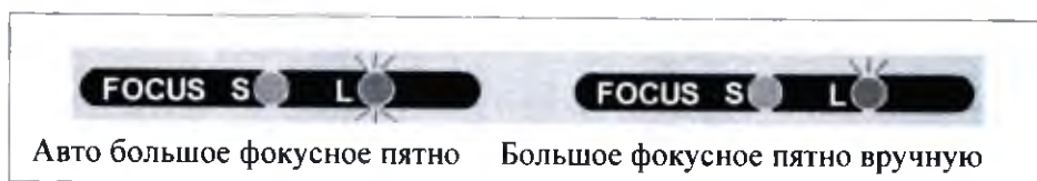
Рисунок 21 – Авто (слева) и ручной (справа) выбор фокусного пятна в RAD.
