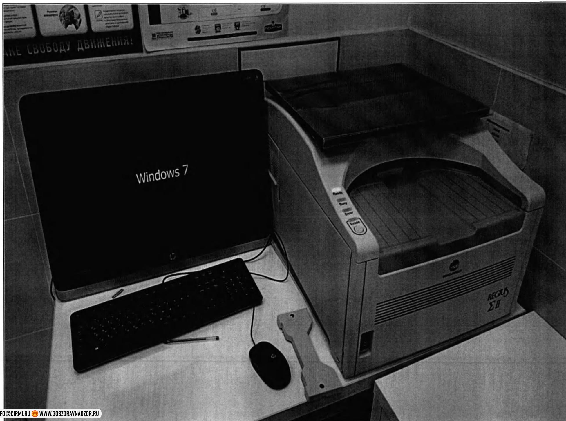
18. Система компьютерной радиографии, включая АРМ лаборанта с комплектом CR-кассет серии REGIUS, производства фирмы Konica Minolta, Япония
