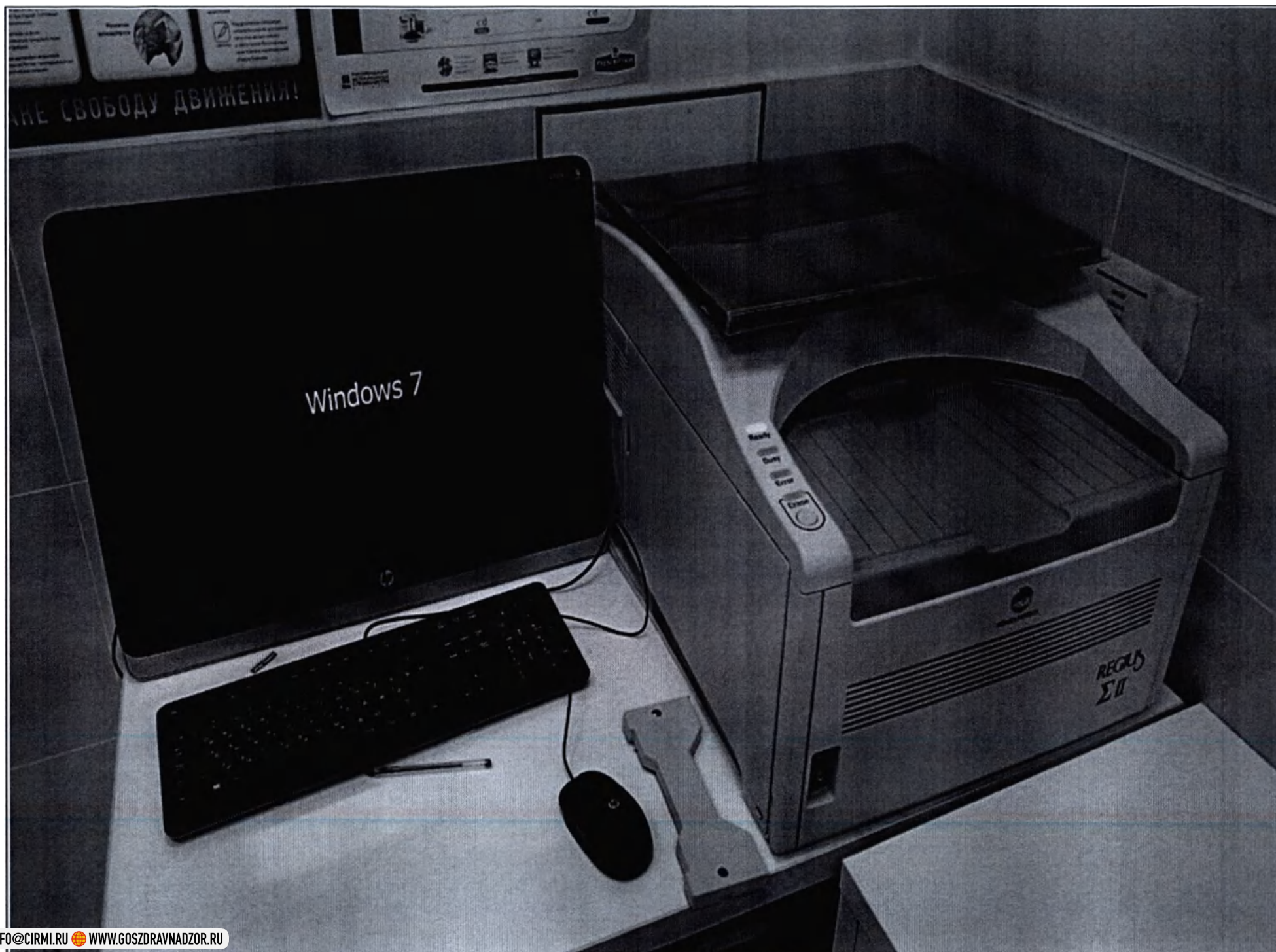
18. Система компьютерной радиологии, включая АРМ лаборанта с комплектом CR-кассет серии REGIUS, производства фирмы Konica Minolta, Япония
