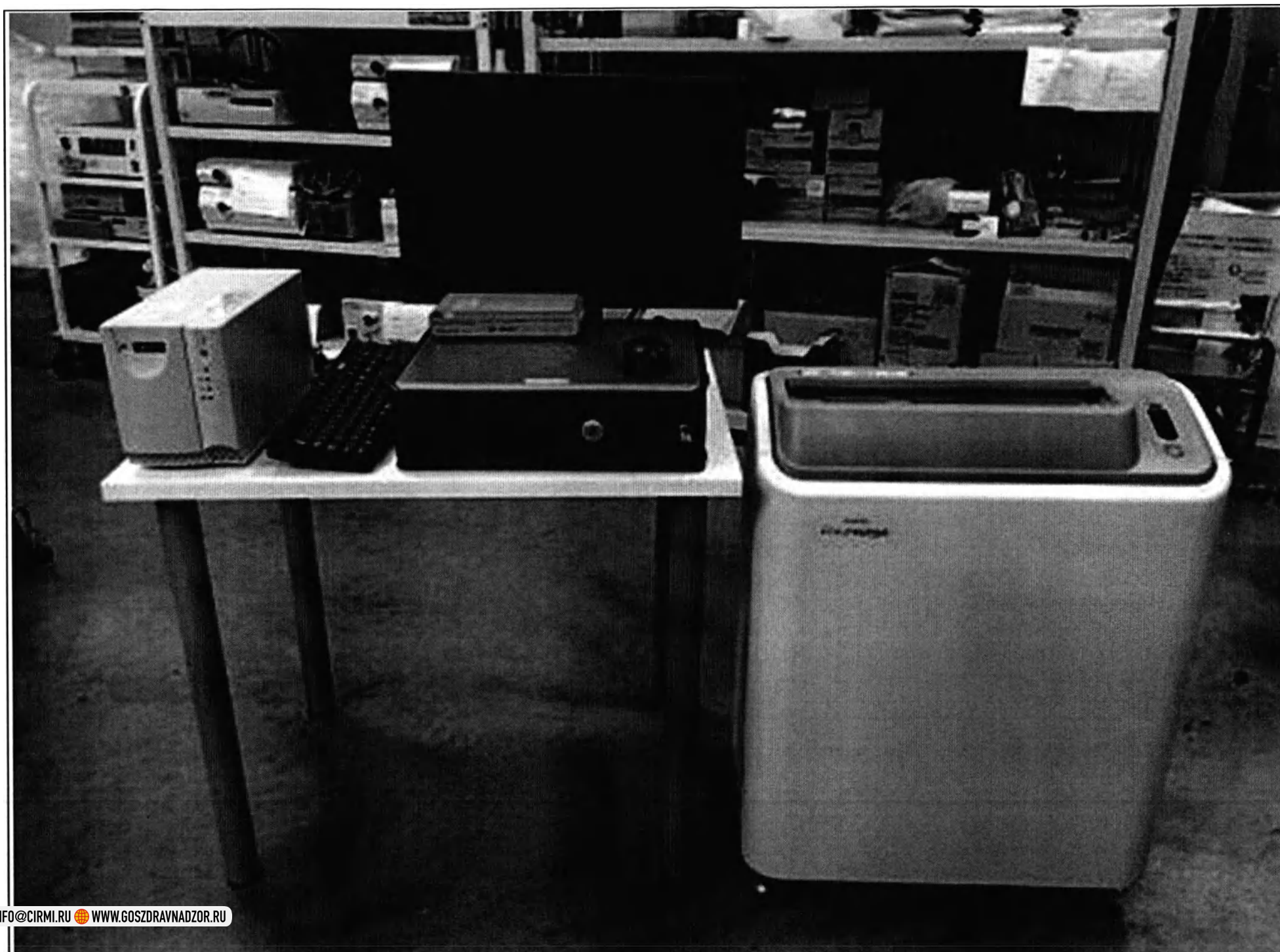
18. Система компьютерной радиографии, включая АРМ лаборанта с комплектом CR-кассет серии FCR, производства Fujifilm, Япония
