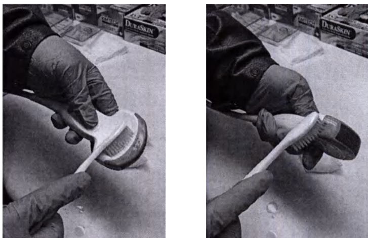
Рисунок 5-4 Чистка датчика щеткой
