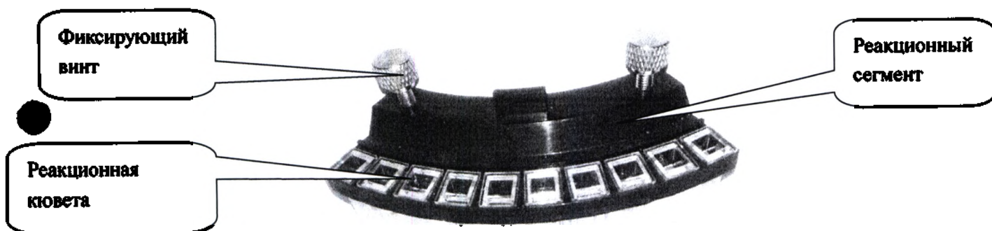
Рисунок 4-5. Реакционный сегмент с кюветами
