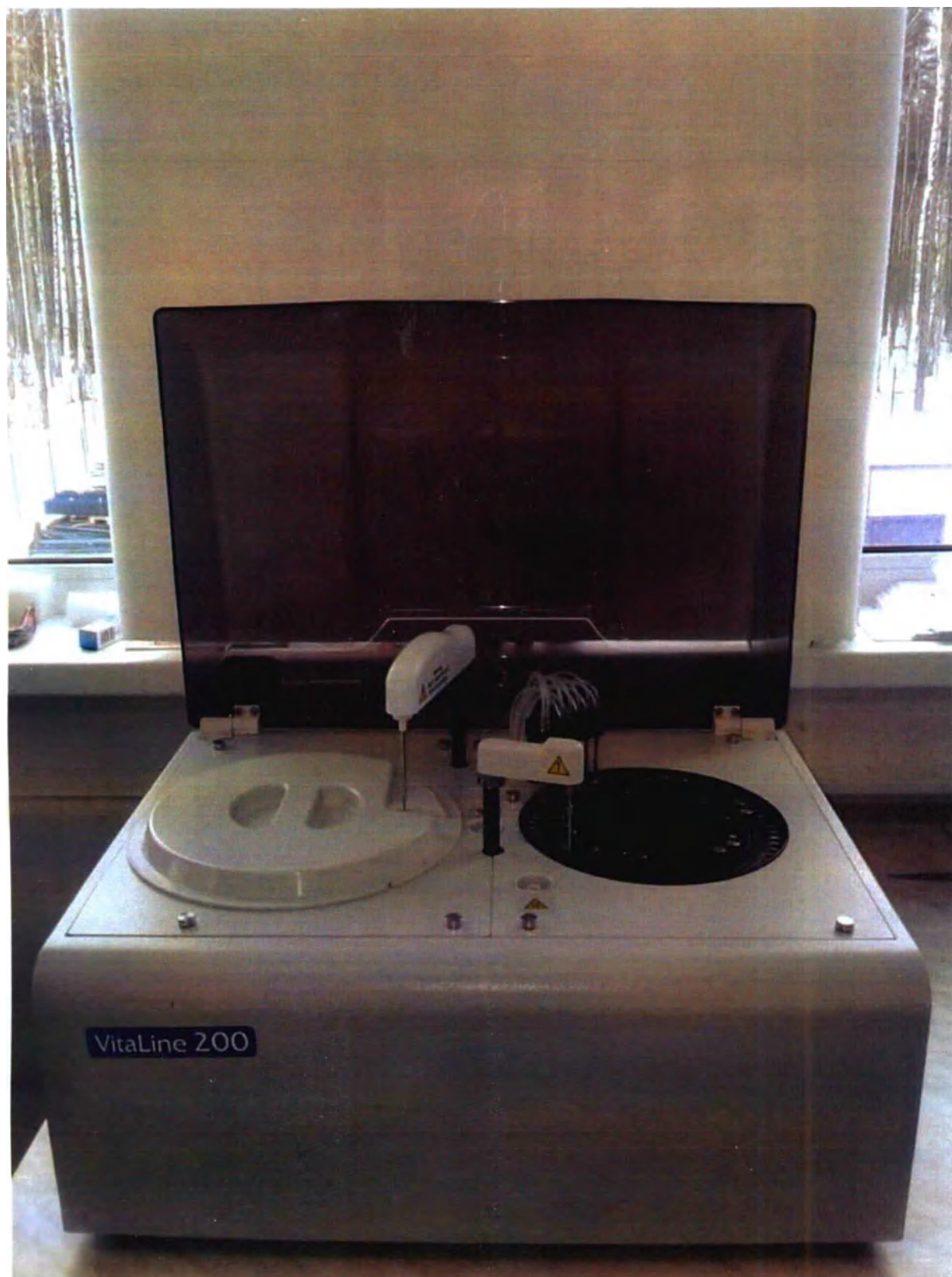
Фото 1. Анализатор автоматический для биохимического и иммунотурбидиметрического анализа «ВитаЛайн 200» (VitaLine 200). Общий вид
