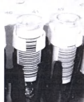
Расположение пробирок для образцов в карусели
