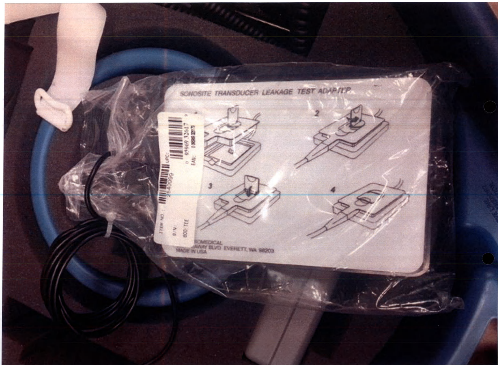
21. Набор для определения тока утечки датчиков TEEх, TEEхi: Адаптер датчика SonoSite;
