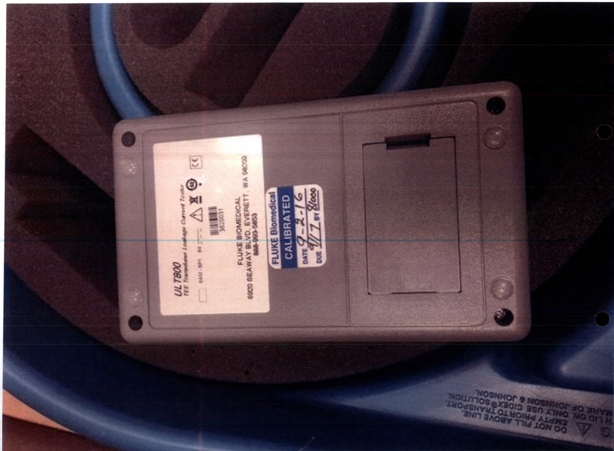
21. Набор для определения тока утечки датчиков TEEх, TEEхi: Мультиметр;
