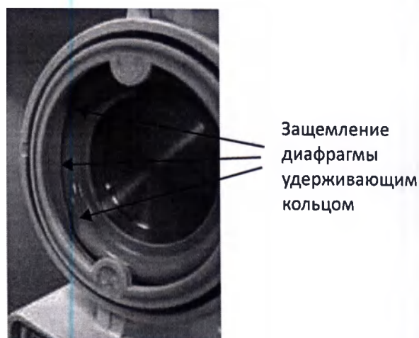
Рисунок 10-8: Защемление диафрагмы картриджа eSYS
