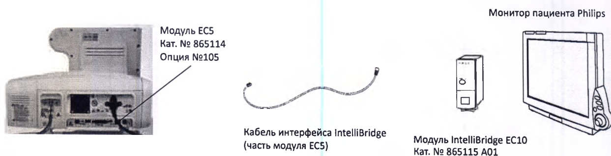
Рисунок В-3: Подключение к монитору Philips с помощью IntelliBridge EC10
