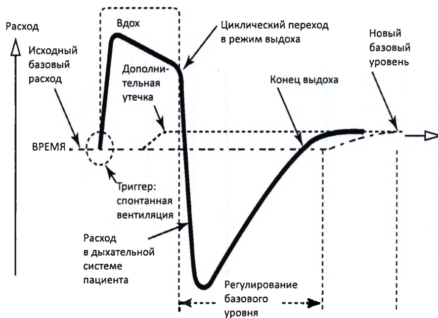
Рисунок 4-4: Регулирование потока выдоха
