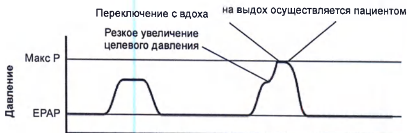
Рис. 6-2. Кривая режима PPV — предельное значение Макс. P
