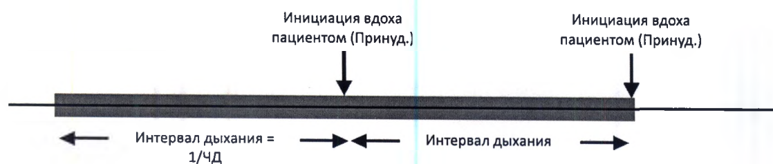
Рисунок 4-14: Интервал дыхания в режимах SIMV
