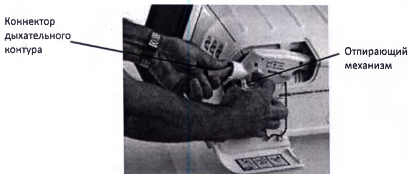
Рисунок 10-13: Извлечение картриджа eSYS
