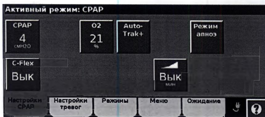
Рисунок 4-17: Элементы управления режима CPAP
