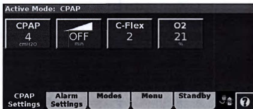
Рис. 4-6. Элементы управления режима CPAP
