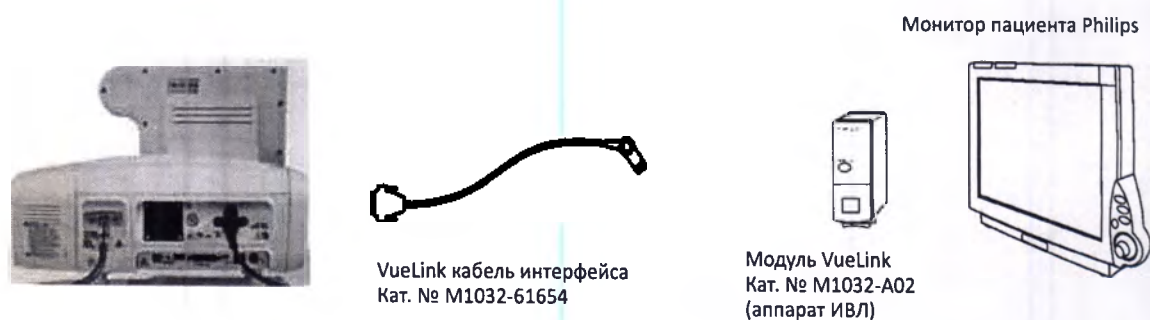
Рисунок В-2: Подключение к монитору Philips с помощью VueLink
