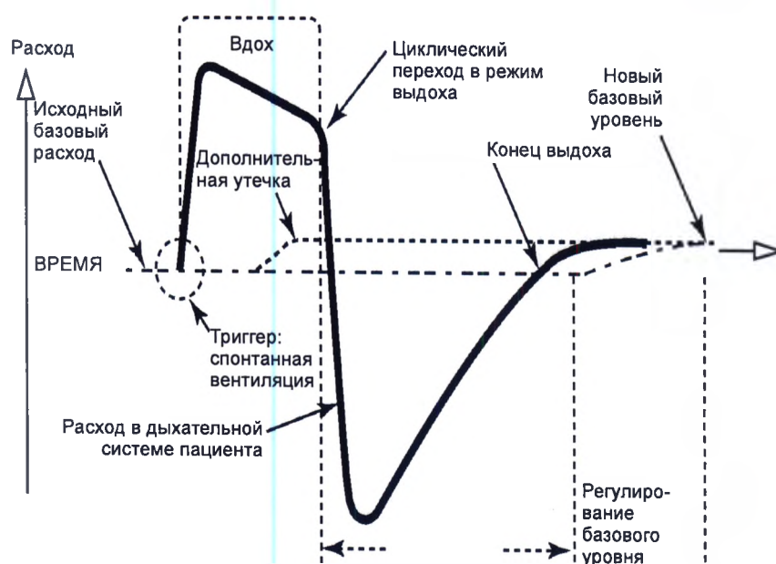
Рис. 4-4. Регулирование потока выдоха
