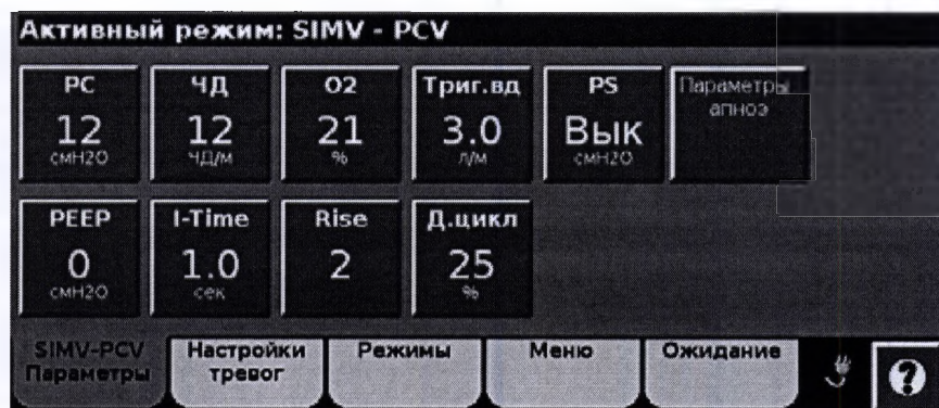
Рисунок 4-16: Элементы управления для режима SIMV-PCV
