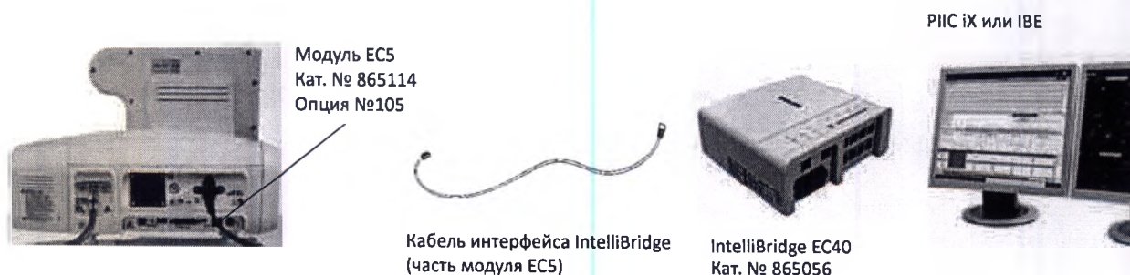
Рисунок В-4: Подключение к Philips IntelliBridge Enterprise с помощью IntelliBridge EC40
