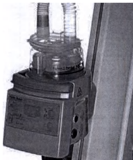
Рисунок 5-1: Увлажнитель на стойке аппарата ИВЛ
