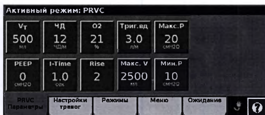
Рисунок 4-11: Элементы управления в режиме PRVC
