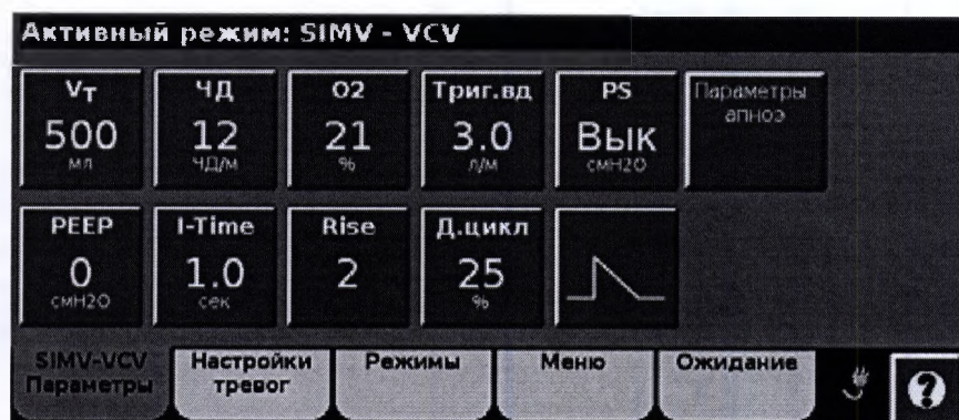
Рисунок 4-15: Элементы управления для режима SIMV-VCV
