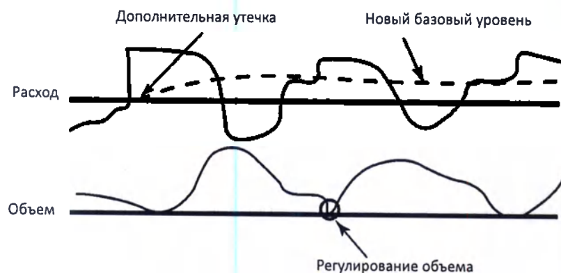
Рисунок 4-5: Регулирование дыхательного объема
