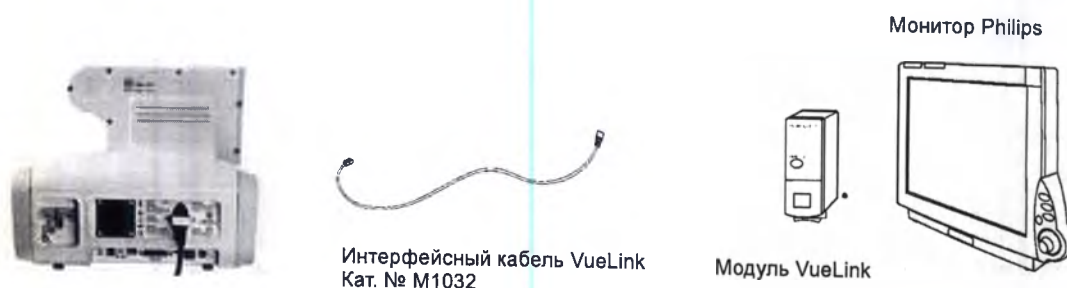
Рис. В-4. Подключите аппарат к монитору пациента Philips посредством VueLink
