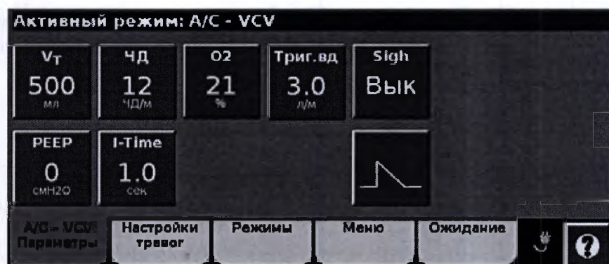
Рисунок 4-7: Элементы управления в режиме A/C-VCV
