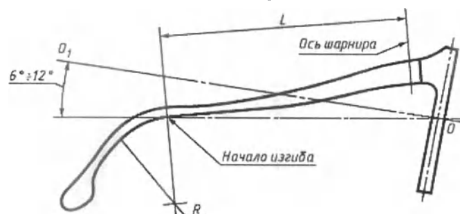
Рисунок 6 - Размеры, определяющие положение заушника относительно рамки оправы
