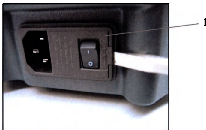
Под крышкой переключателя питания находится два предохранителя Рисунок 6-10. Замена предохранителя: Вскрытие крышки
