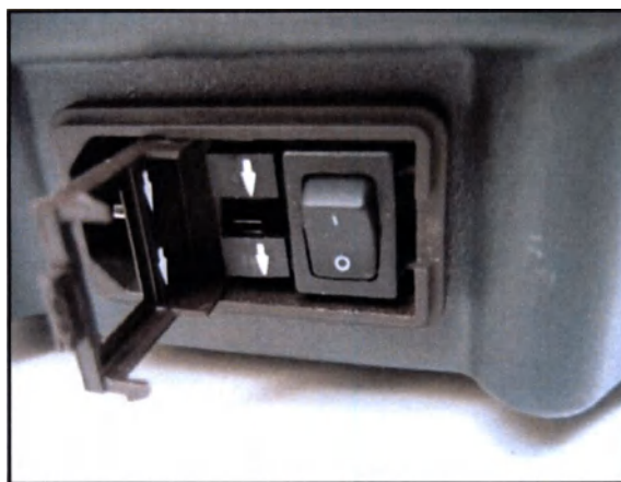
Рисунок 6-11. Замена предохранителя: Извлечение держателей
