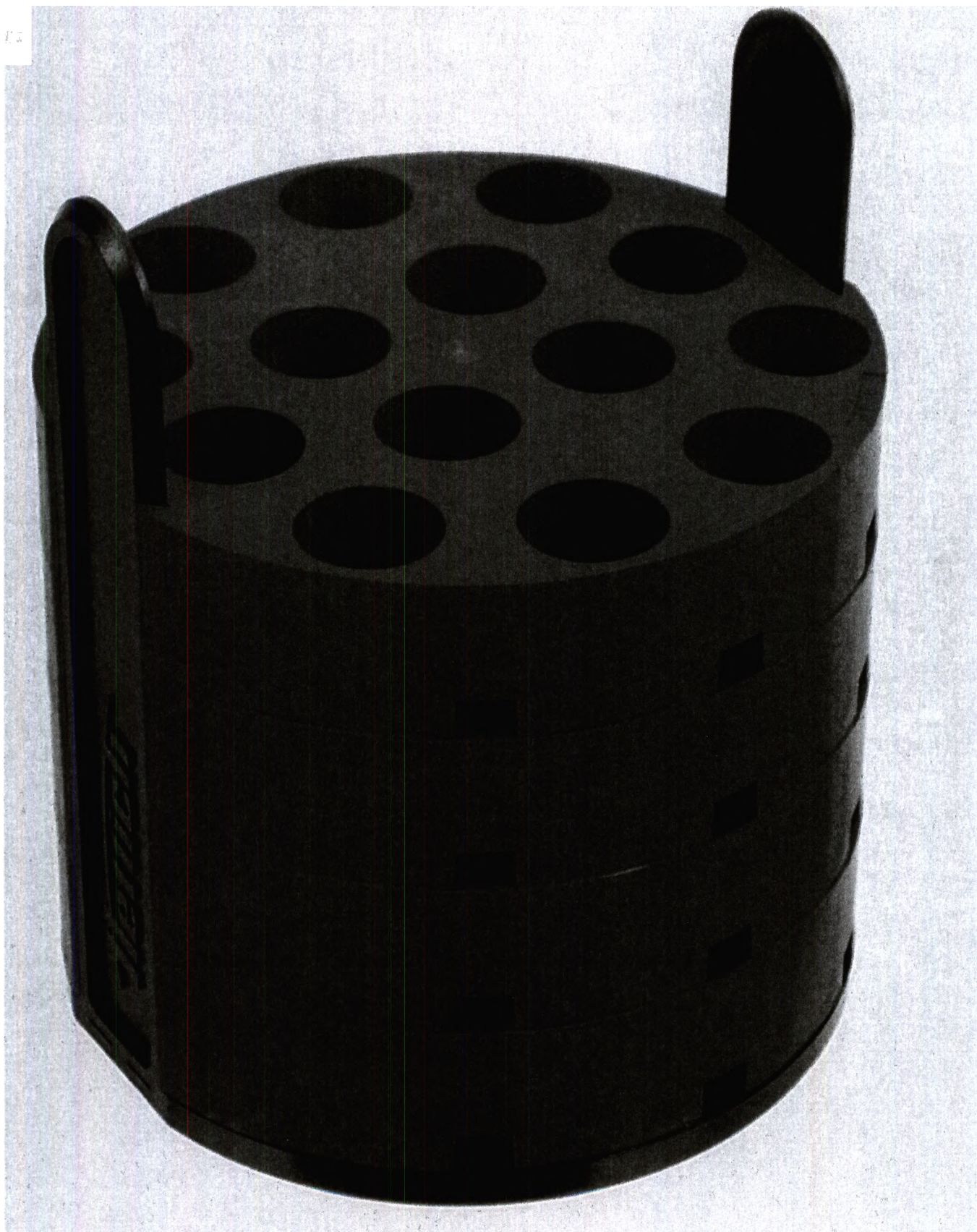
Адаптер 14-местный, для конических пробирок объемом 12/15 мл
