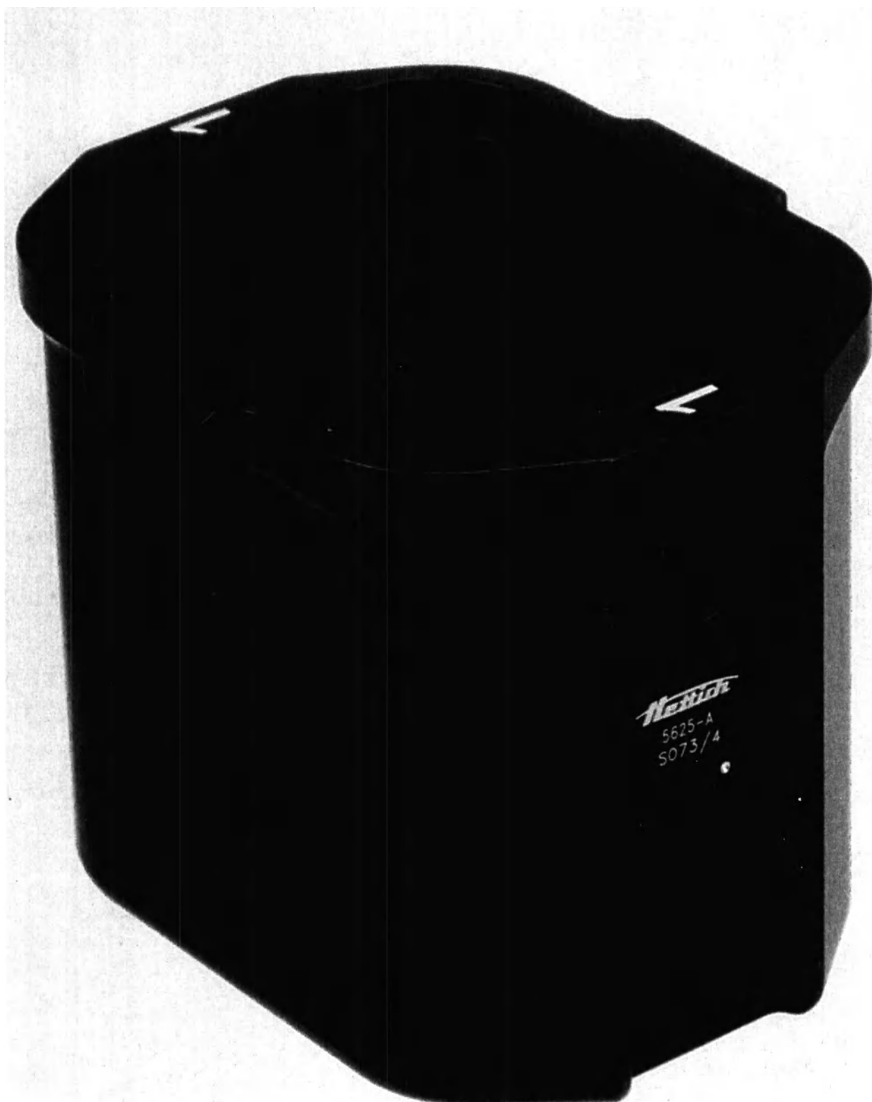
Подвес одноместный, прямоугольной формы, для 4-местных роторов, для сборных адаптеров различной конфигурации
