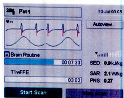
Рис. 56: Отображение физиологических сигналов (сигнала ВКГ и сигнала дыхания) в области состояния пациента с указанием фактической ЧСС.
