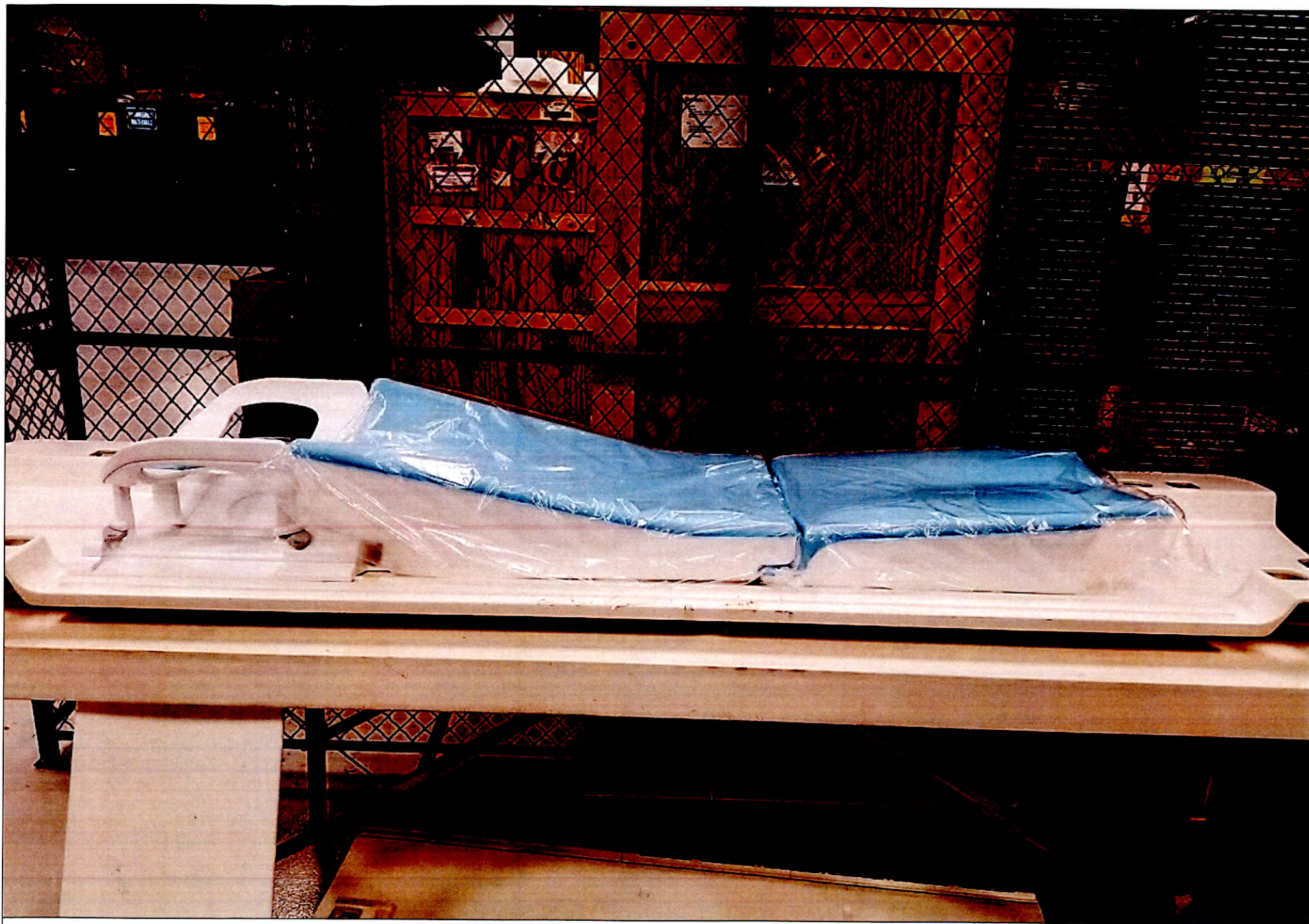
4.10е. Катушка dS Breast Coil 7ch 1.5T для Prodiva 1.5T CX: Наклонная опора с застёжками-липучками на нижней стороне.
