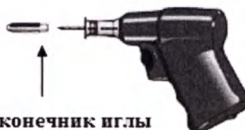
Рисунок 3 – Схема удаления защитного наконечника иглы
