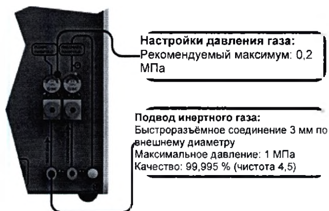
Рисунок 20: Линия инертного газа на панели
