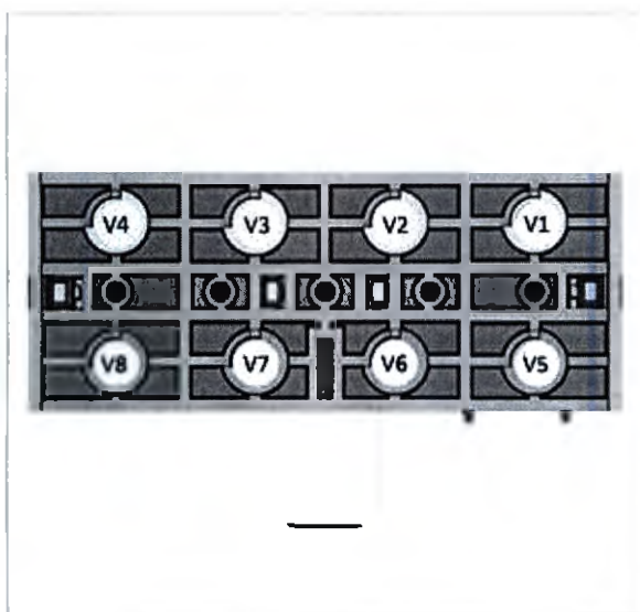
Рисунок 12: Идентификация клапанов и конусов Люэра (вид сзади)
