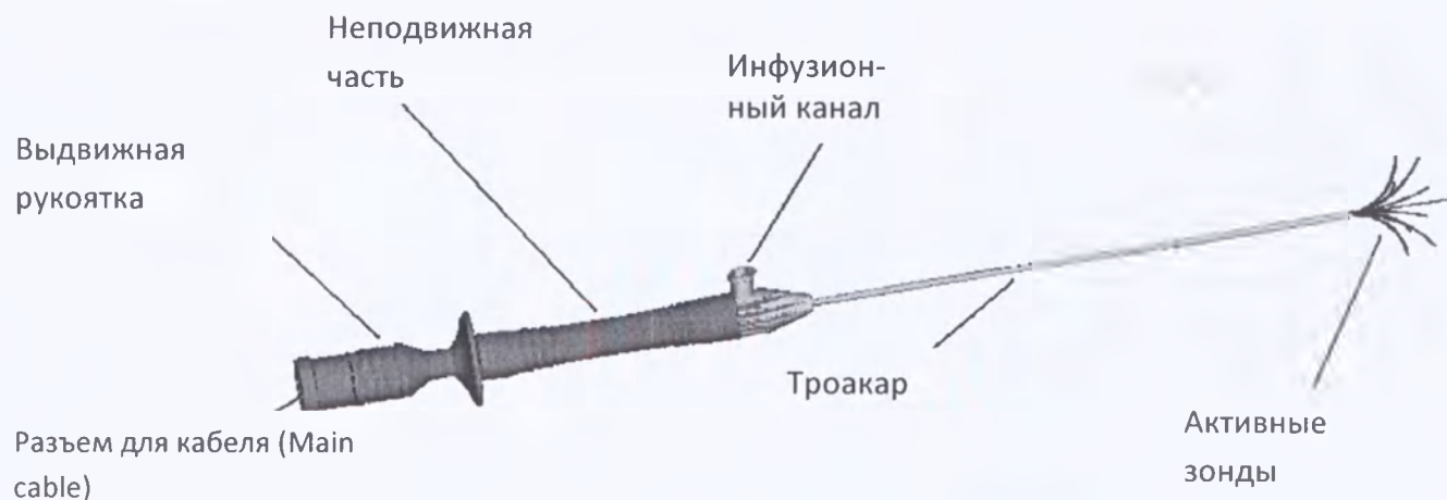
Рис 6. Расположение температурных датчиков - сенсоров инструмент StarBurst SDE При работе с инструментом электрохирургическим StarBurst, StarBurst XL, StarBurst XL MRA, StarBurst Semi-Flex, применяется инфузия для смягчения огрубевших тканей в процессе абляции и охлаждения зондов. Для этого, в инфузионный канал, при помощи стандартного шприца для инъекций 10-20 мл. (не входит в комплект поставки) вводится раствор натрия хлорида.
