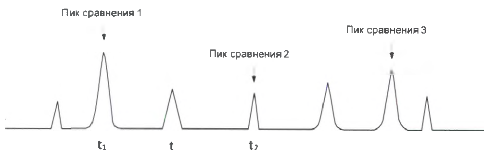
Рисунок А.15 Метод относительного времени удерживания с несколькими пиками сравнения
