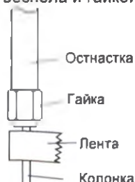
Рис. 2.24 Пометка колонки липкой лентой
