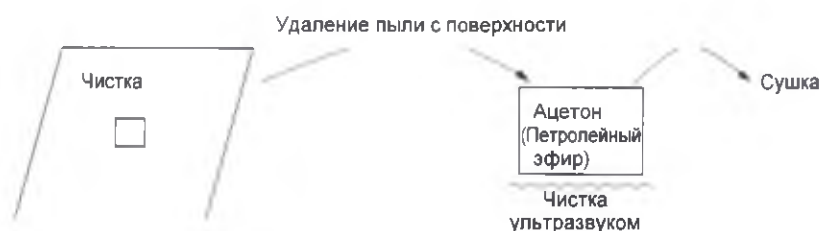
Рисунок 10.14 Чистка ионного источника и отражающего электрода
