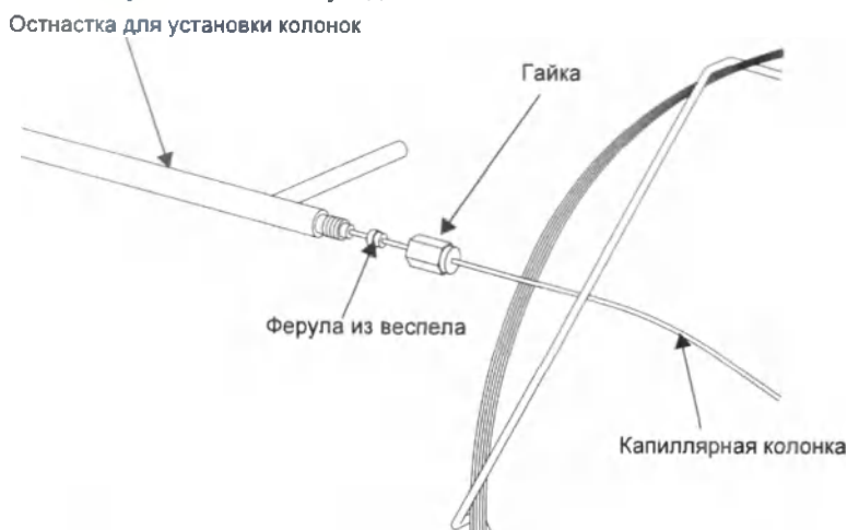
Рис. 2.9 Использование остнастки для установки колонок
