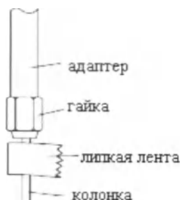
Рис. 2.24 Фиксация колонки липкой лентой
