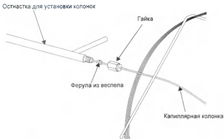
Рис. 2.25 Использование остнастки для установки колонок
