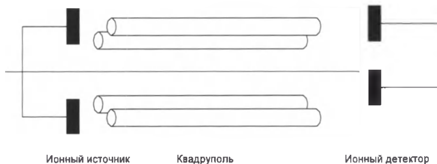
Рисунок F.2 Схема квадрупольного масс-спектрометра
