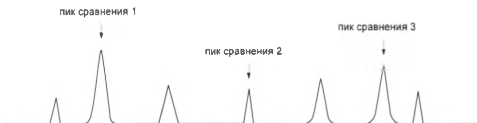
Рисунок А.15 Метод относительного времени удерживания с несколькими пиками сравнения
