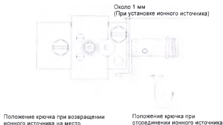
Рисунок 10.7 Положение крючка (GCMS-QP2010 Ultra)
