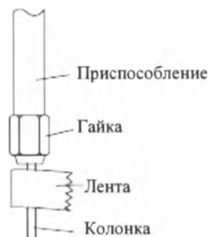
Маркировка колонки липкой лентой
