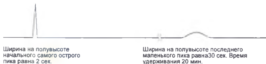
Рисунок А.22 Определение значения T.DBL
