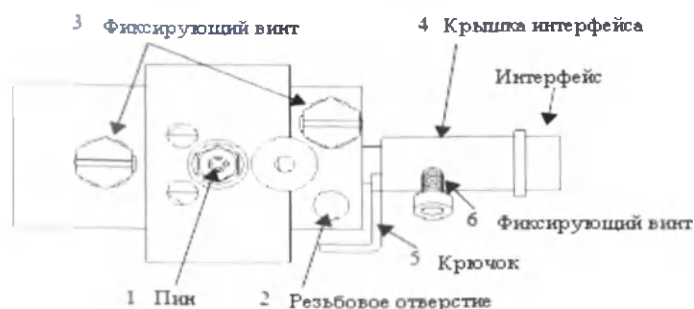
Рис. 10.5 Схема ионного источника после удаления филаментов (GCMS-QP2010 Ultra)
