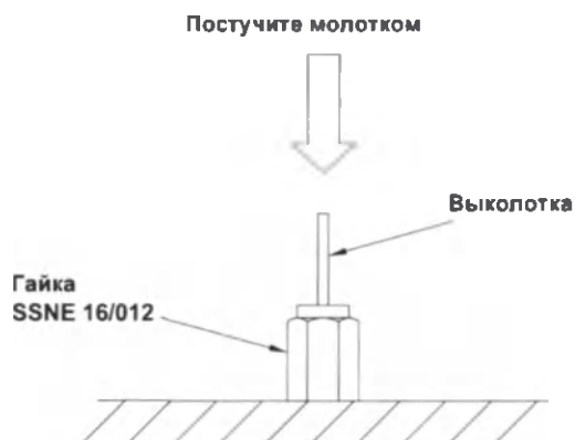
Рис. 2.28 Удаление ферулы при помощи выколотки
