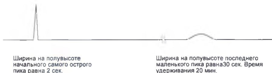
Рисунок А.11 Определение значения T.DBL, если не известна точка удвоения ширины пика
