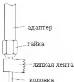
Рисунок 2.27 Фиксация колонки липкой лентой
