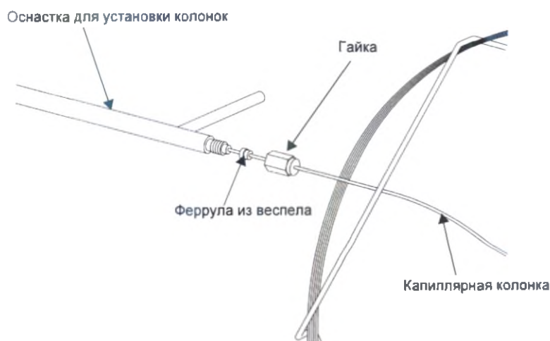
Использование оснастки для установки колонок
