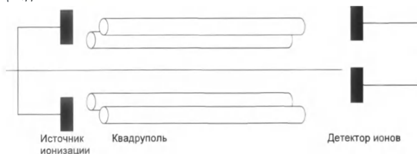
Рис. F.2 Схема квадрупольного масс-спектрометра
