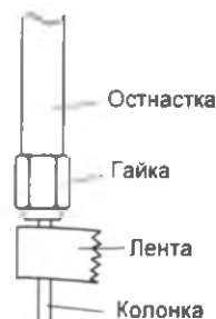
Рис. 2.8 Пометка колонки липкой лентой
