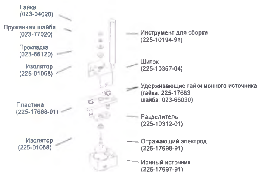
Рисунок 10.9 Ионный источник и инструмент для сборки/разборки (GCMS-QP2010 Ultra)
