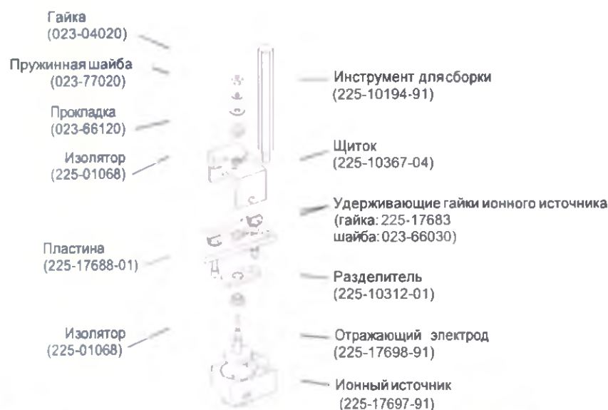
Рисунок 10.9 Ионный источник и инструмент для сборки/разборки (GCMS-QP2020)
