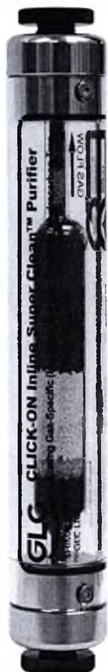
248. Фильтры (S, P, Sn) для пламенно-фотометрического детектора – от 1 до 10 шт.
