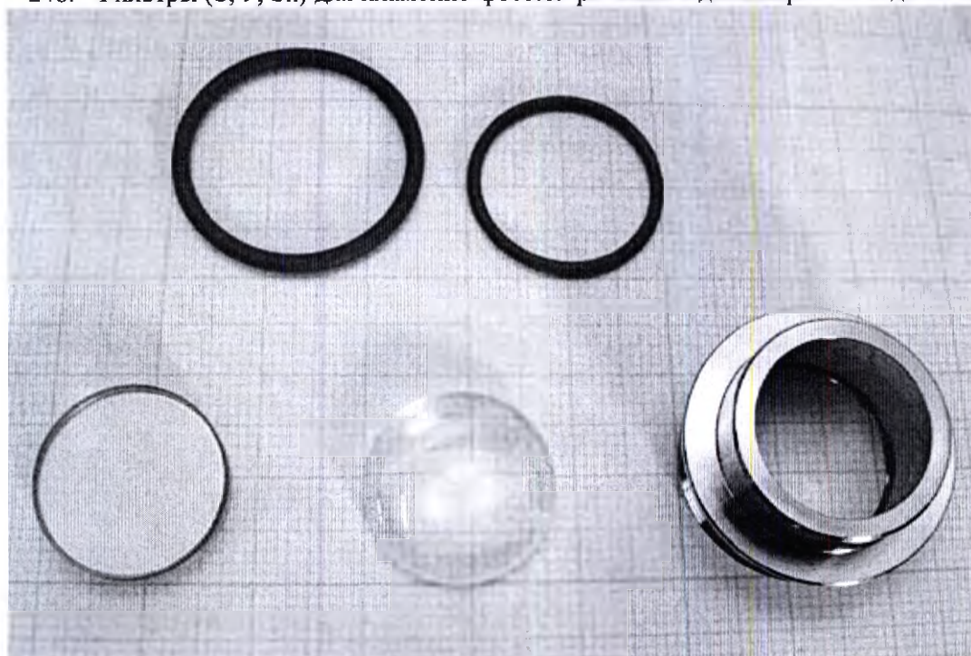
248. Фильтры (S, P, Sn) для пламенно-фотометрического детектора – от 1 до 10 шт.
