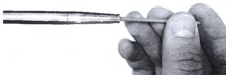
Рисунок 16.4. Очистка внутренних линз аппликатора
