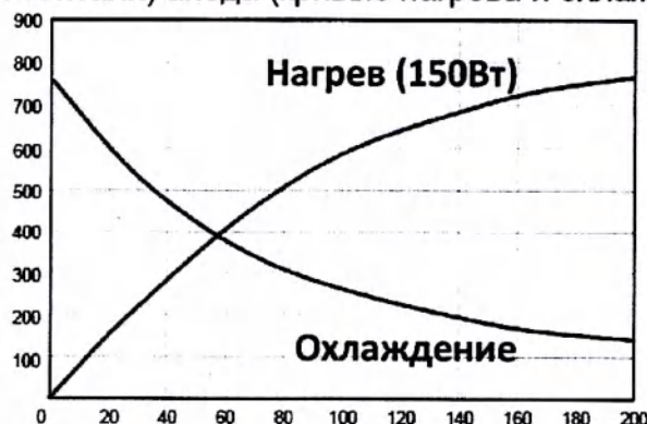
Рисунок 14.6 – Зависимость накопленной теплоты (кДж, по вертикали) от времени (минут, по горизонтали) рентгеновской трубки (кривые нагрева и охлаждения рентгеновской трубки).
