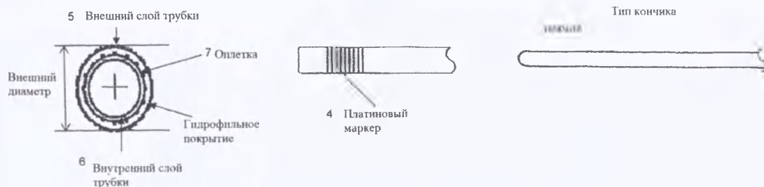
Рисунок 1 – Строение микрокатетера внутрисосудистого Mogul
