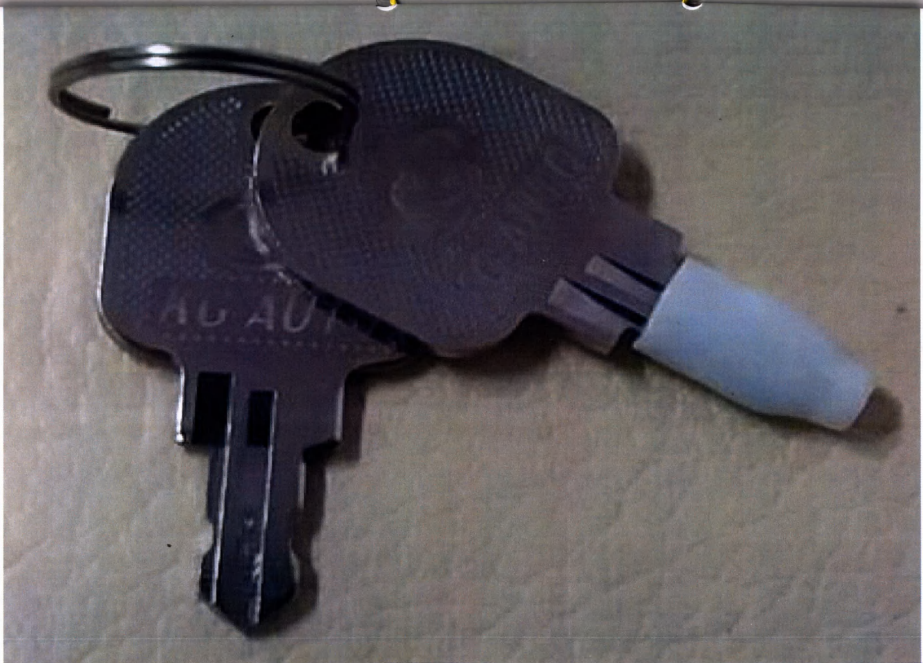
11. Ключ включения-выключения подачи электроэнергии к оборудованию.
