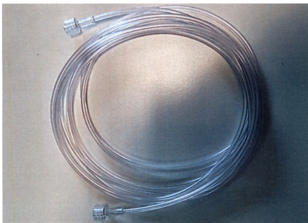
Рисунок 6 - Трубка для отбора проб газа с коннектором типа Луер Мэйл (Luer Male)/Луер Мэйл (Luer Male), внутренний диаметр 1.68 мм, внешний диаметр 3.33 мм, длиной 3 м.
