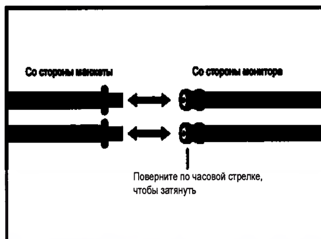
Рис. 7-1. Подсоединение воздушного шланга к трубкам манжеты
