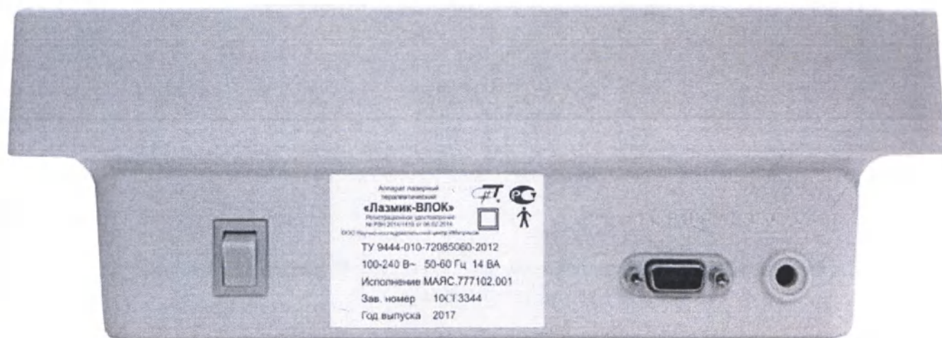
Рис. 2. Внешний вид аппарата со стороны задней панели, слева направо: сетевой выключатель, этикетка (шильдик) с указанием заводского номера аппарата и даты производства, разъём для подключения внешнего управления, разъём для подключения специального блока питания (адаптера). Маркировка ГОСТ Р МЭК 60601-1-2010:
