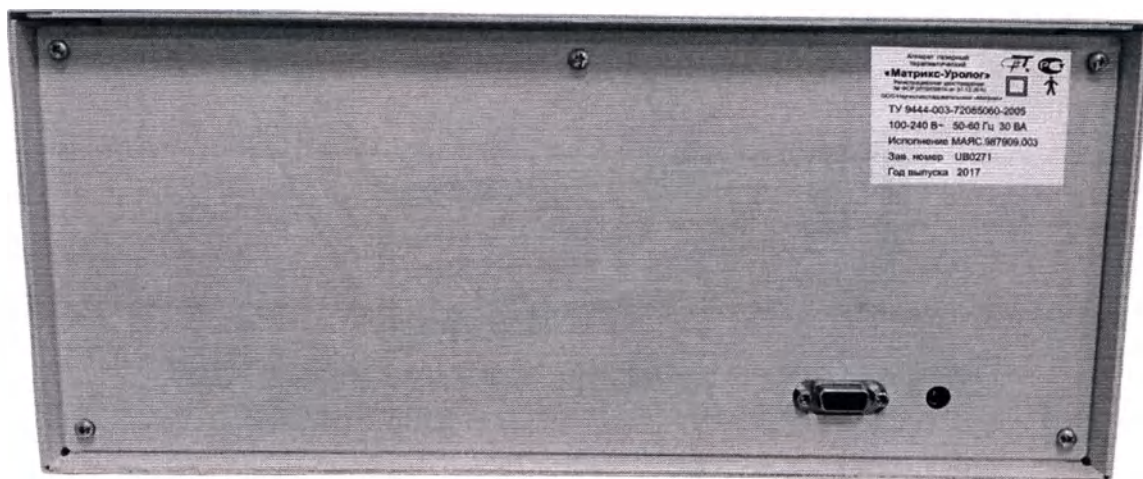
Рис. 2. Внешний вид аппарата со стороны задней панели, слева направо: разъём для подключения внешнего управления, разъём для подключения специального блока питания (адаптера).
