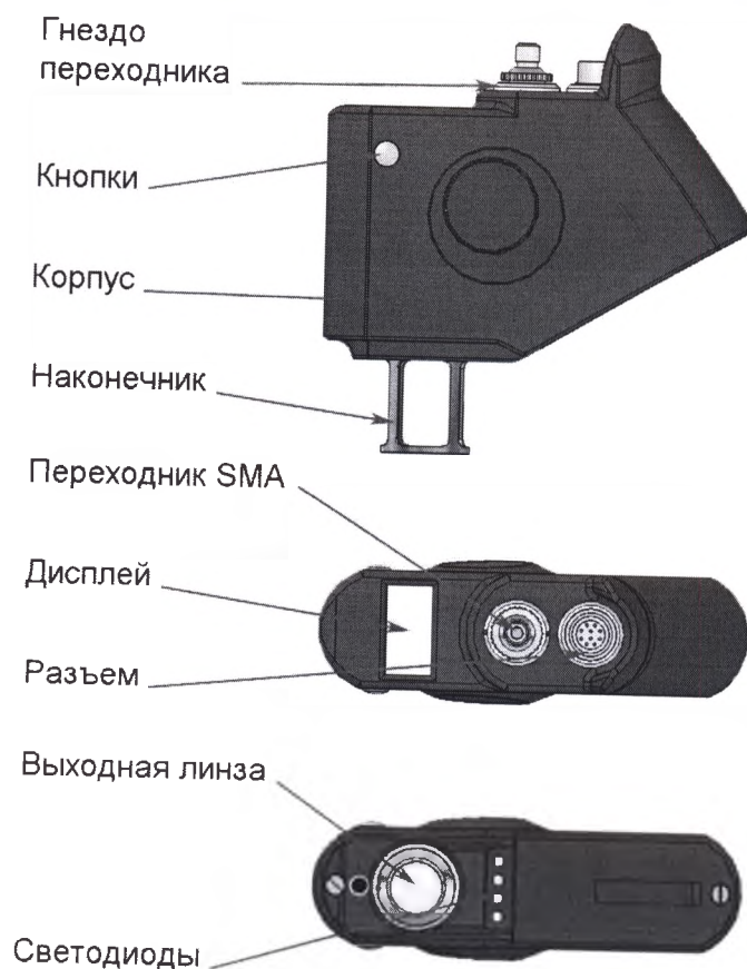
Рис. 3-13. Конструкция пера со сканирующим устройством
