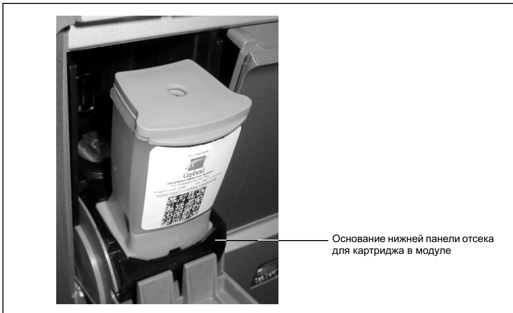
Рис. 5-8. Картридж GeneXpert, размещенный на основании нижней панели отсека модуля, предусмотренного для картриджа.
