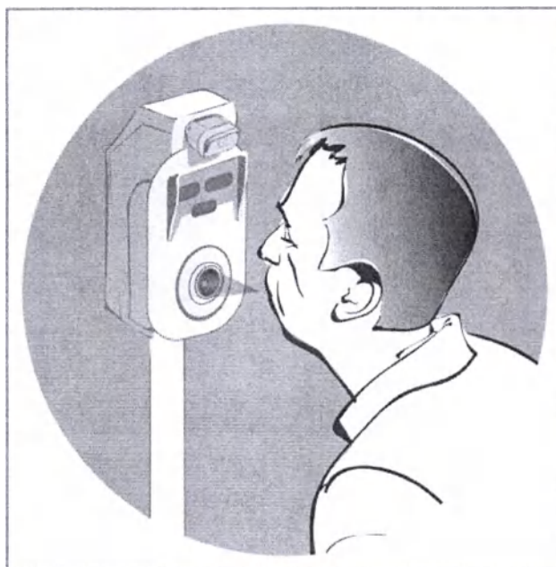
Рис. 2.3.5.16 – Измерение температуры тела и измерение паров этанола в выдыхаемом воздухе
