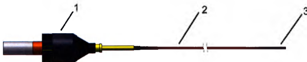
Рис. 2. Зонд для литотрипсии: 1- разъем, 2 - передающая часть, 3 - головка зонда.
