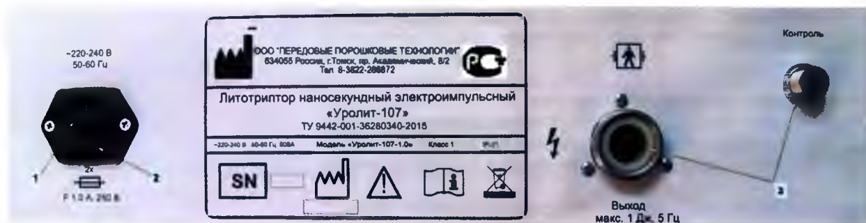
Рис. 4. Задняя панель литотриптора наносекундного электроимпульсного «Уролит-107» по ТУ 9442-001-36280340-2015, модель «Уролит-107-1.0» - для лечения желчекаменной болезни:
