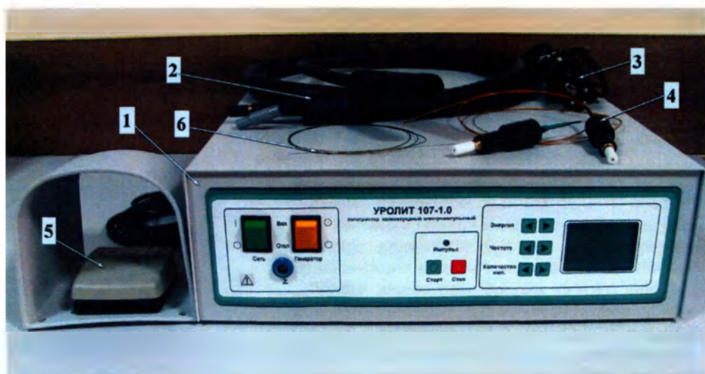
Рис.1а. Литотриптор наносекундный электроимпульсный «Уролит-107» по ТУ 9442-001-36280340-2015, модель «Уролит-107-1.0» - для лечения мочекаменной болезни:
