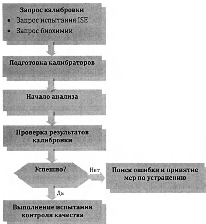
Figure 2.9 Процедура калибровочного испытания
