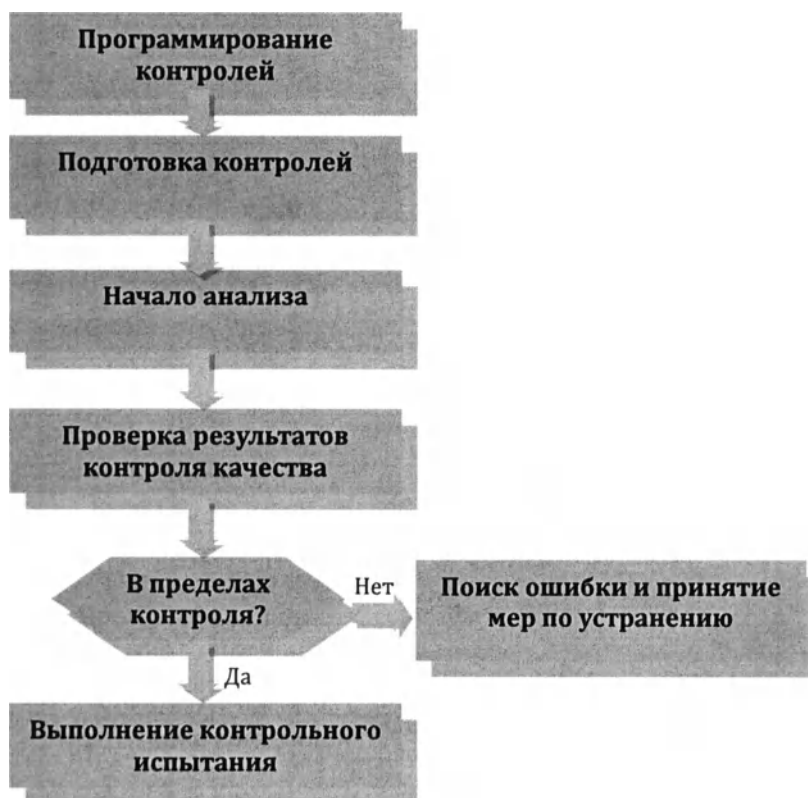
Figure 2.13 Порядок выполнения испытания контроля качества
