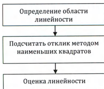
Figure 12.2 Процедура расчета данных при кинетических измерениях
