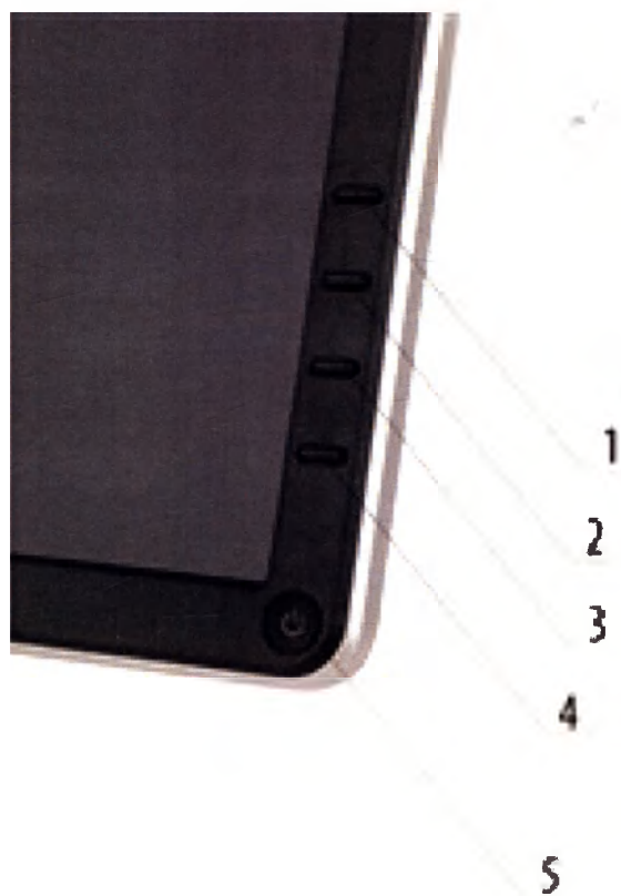
Рис. 8. Передняя панель Проектора (1-5 - кнопки управления).
