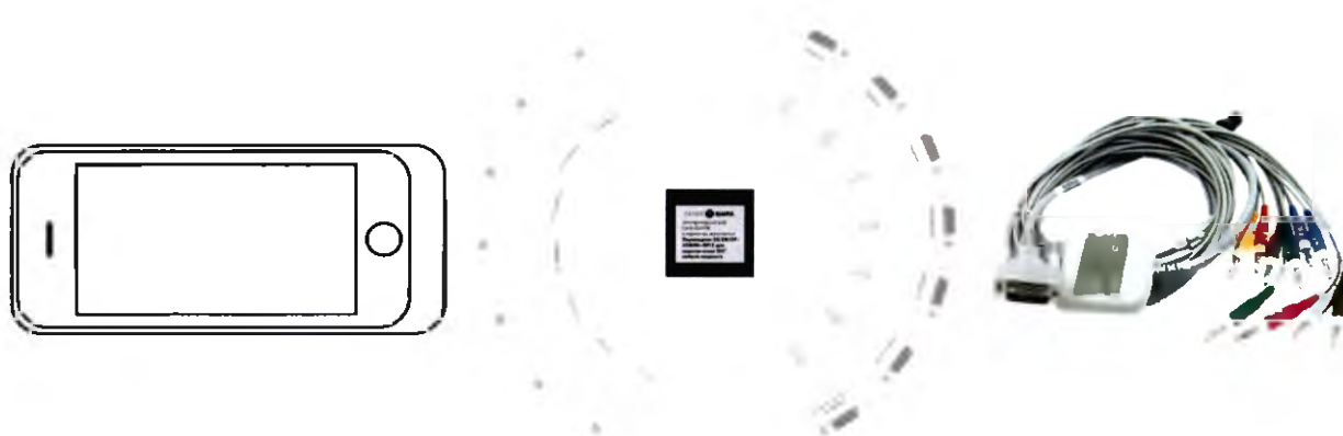
Рисунок 2 - соединение изделия с ЭКГ кабелем пациента при помощи переходника CQ DB15F – USB/Mc-SP/2
