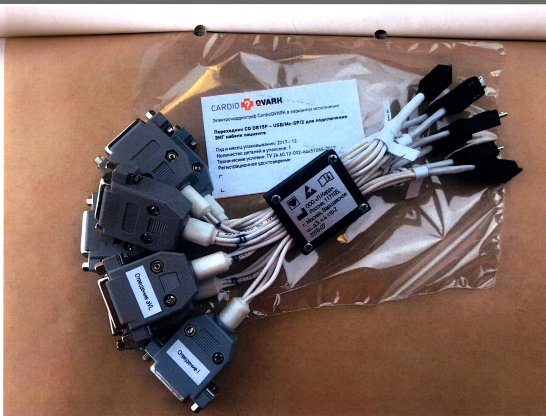
8 Переходник CQ DB15F – USB/Мс-SP/2 для подключения ЭКГ кабеля пациента
