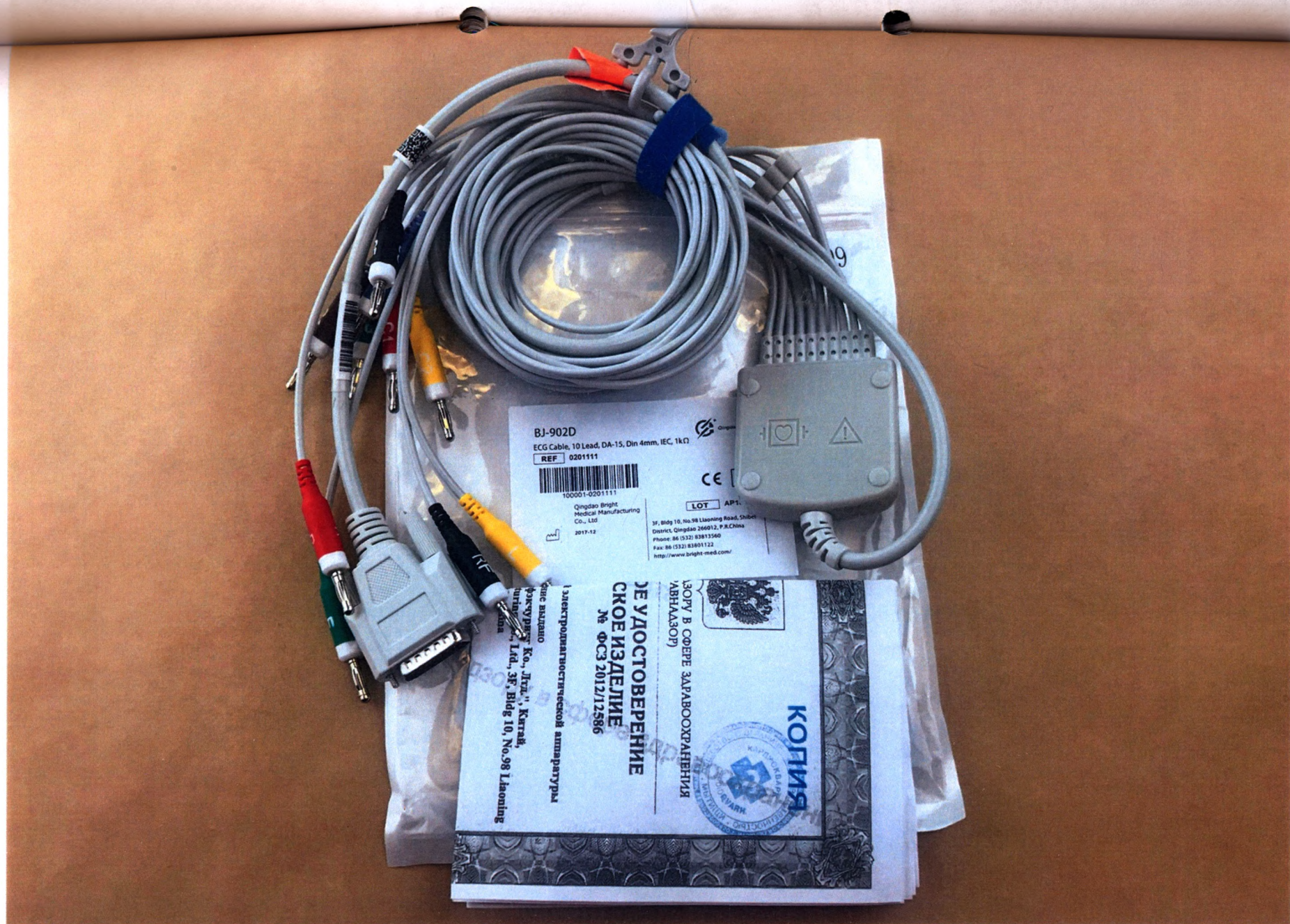
11 ЭКГ кабель пациента REF 0201111, BJ-902D, IEC/DIN, 4 мм (K093D) с защитой от разряда дефибриллятора
