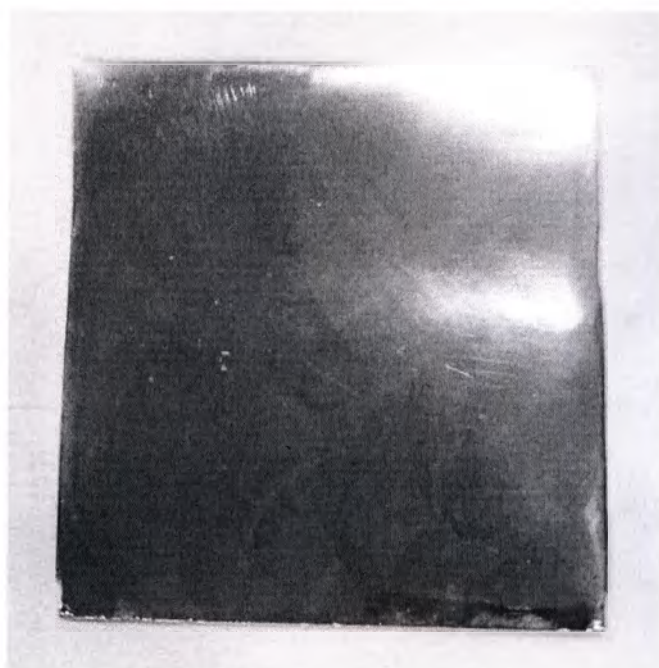
Защитно-упрочняющее покрытие из нитрида циркония на основе из кобальто-хромового сплава
